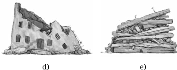
Ryc. 2. Zawalenie skośne (a), zawalenie z nawisem (b), zawał (c), zawalenie boczne (d), zawalenie typu pancake (e)
