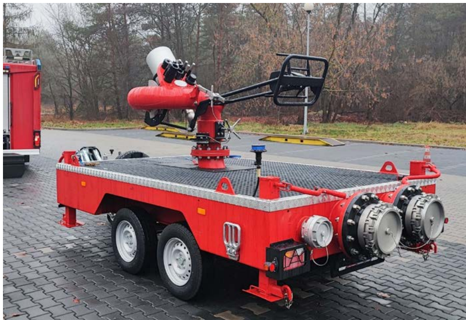
Ryc. 4. Działko wodno-pianowe przewoźne zamontowane na przyczepie
