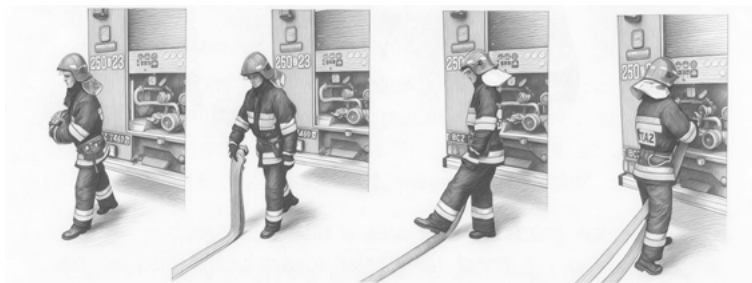
Ryc. 5. Łączenie węża z nasadą samochodu gaśniczego
