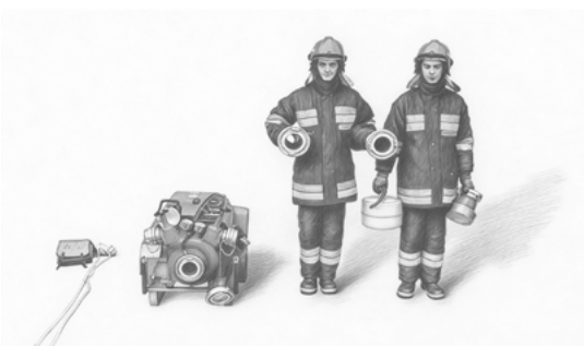
Ryc. 13. Przenoszenie armatury wodnej do sprawiania linii ssawnej
