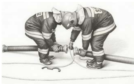
Ryc. 16. Zabezpieczenie węża pętlą z liny
