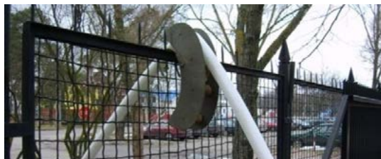
Ryc. 4. Linia węzowa prowadzona przez przeszkody (parkan)
