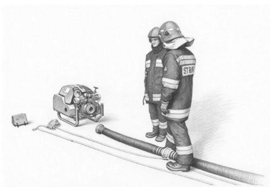
Ryc. 17. Przejście przodownika do podłączenia ostatniego odcinka węży
