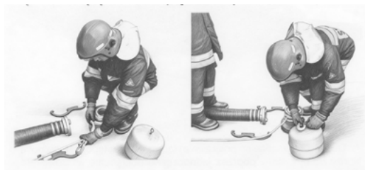
Ryc. 14. Zabezpieczenie smoka i pływaka linką ratowniczą
