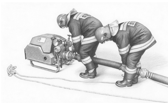
Ryc. 18. Połączenie węża z nasadą ssawną motopompy
