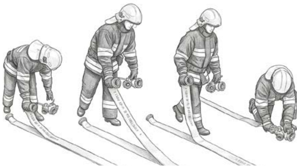
Ryc. 7. Połączenie węża W 75 z rozdzielaczem
