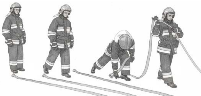
Ryc. 19. Odwadnianie linii węzowych
