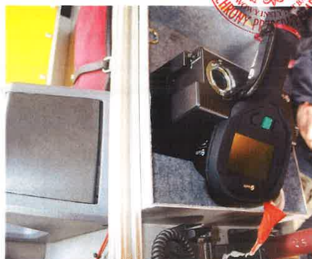
Fot. 5 i 6. Sprawdzenie możliwości montażu kamery w pojeździe pożarniczym. Źródło: CNBOP-PIB.
