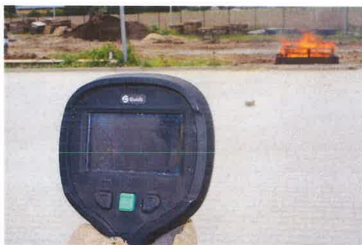
Fot. 7. Sprawdzenie działania kamery w pożarze testowym. Źródło: CNBOP-PIB.
