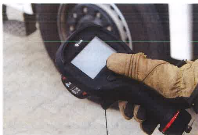
Fot. 4. Sprawdzenie obsługi kamery w rękawicach strażackich. Źródło: CNBOP-PIB.
