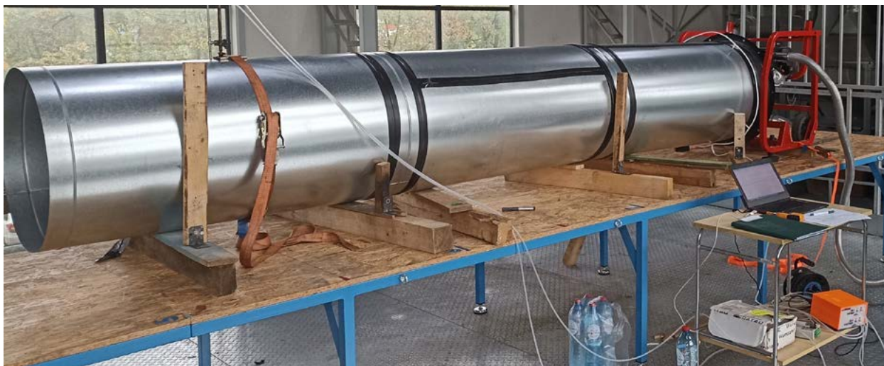
■ Stanowisko do badania charakterystyki parametrów przepływu [objętościowego natężenia przepływu powietrza i ciśnienia] zgodnie z wymaganiami normy PN-EN ISO 5801
