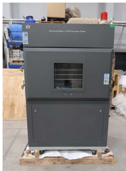
■ Stanowisko Nail Penetration Test do wywoływania wewnętrznego zwarcia w ogniu litowo-jonowym poprzez przebicie ogniwa zaostrozonym prętem
