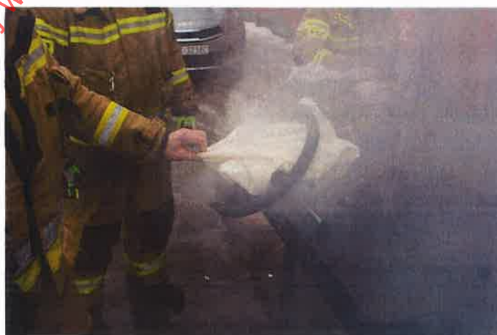
Fot. 6. Kontrolowany wyzwoleńie poduszki powietrznej. Źródło: CNBOP-PIB.
