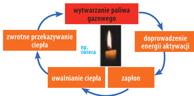
Ryc. 9. Przebieg procesu energetycznego przygotowania materiału do zapalenia
