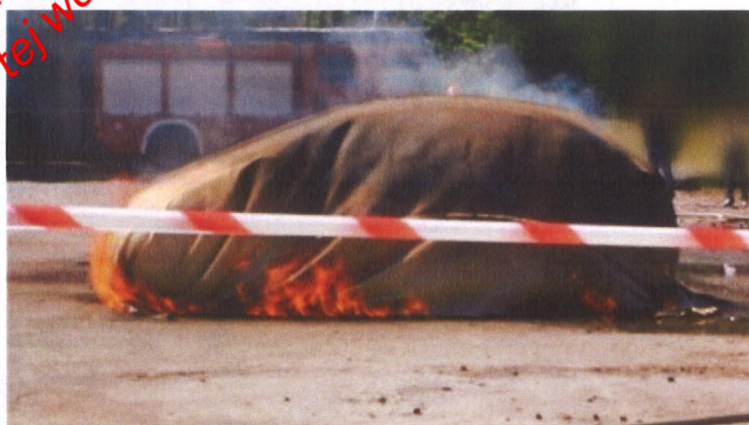
Fot. 19. Pojazd przykryty samochodową płachtą gaśniczą
