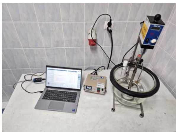
■ Stanowisko do badania temperatury zadziałania tryskaczy i dysz
