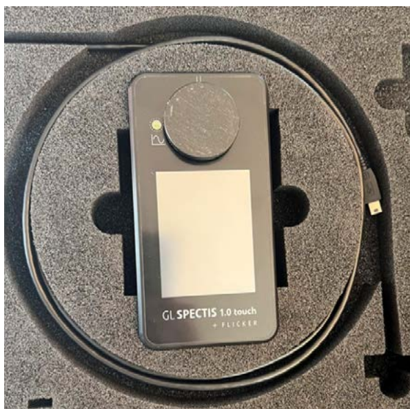
■ Stanowisko do badania parametrów widmowych GL SPECTIS 1.0 Touch + Flicker
