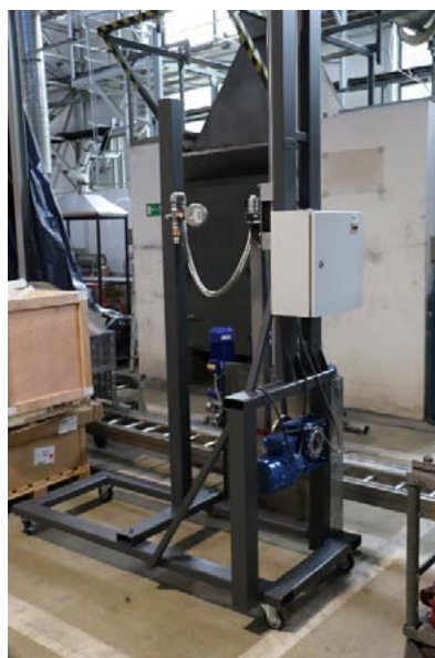
■ Stanowisko do zginania węży elastycznych U-bend
