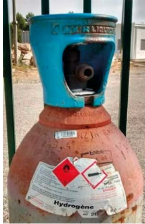
Ryc. 3. Butla do przechowywania wodoru o poj. 50 l
