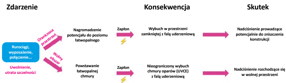
Ryc. 19. Zagrożenia związane z opóźnionym zapłonem wodoru wywołanie utratą szczelności na połączeniach lub nieszczelnościami innych elementów
