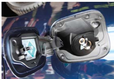
Ryc. 27. Nasada do tankowania wodoru w samochodzie Toyota Mirai
