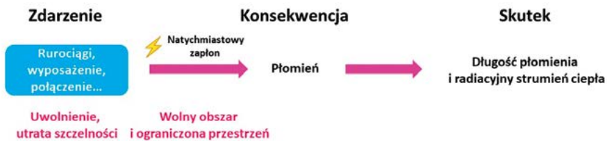
Ryc. 18. Zagrożenia zdarzeniami z natychmiastowym zapłonem wodoru, wywołanymi nieszczelnościami na połączeniach lub podłączeniem nieszczelnych urządzeń
