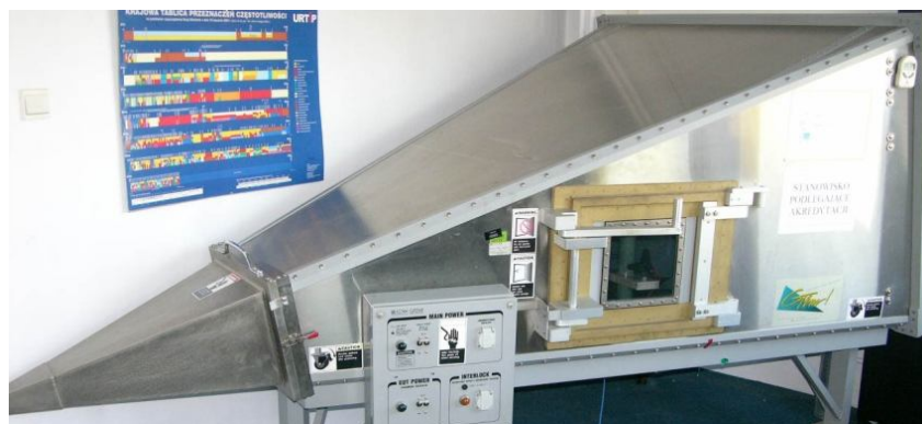
Ryc. 12. Wyposażenie do badania odporności na pola elektromagnetyczne
