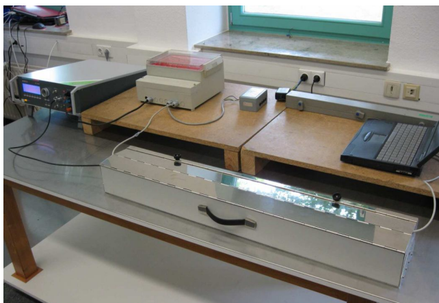
Ryc. 14. Wyposażenie do badania odporności na szybkie zakłócenia impulsowe
