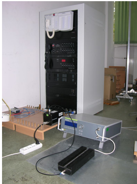
Ryc. 13. Wyposażenie do badania odporności na zaburzenia przewodzone indukowane przez pola elektromagnetyczne
