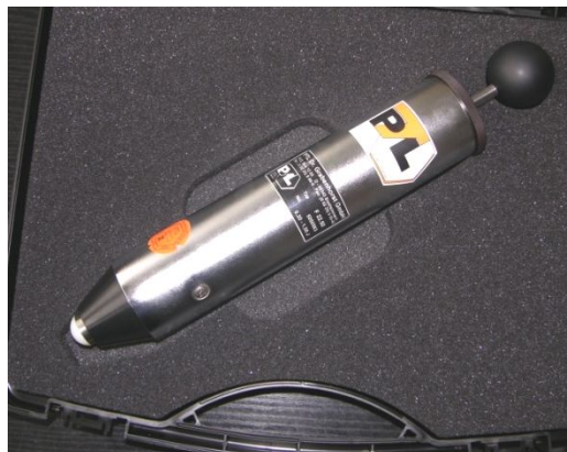
Ryc. 8. Widok młota sprężynowego
