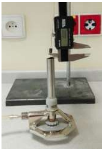
Ryc. 2. Sposób ustawienia termopary z bloczkiem miedzianym względem palnika
