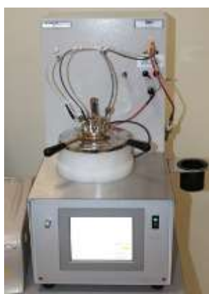
Ryc. 4. Aparat do oznaczania temperatury zapłonu metodą zamkniętego tygla Abła (a) cały aparat, (b) zapłonnik w pozycji zanurzonej w oparach próbki
