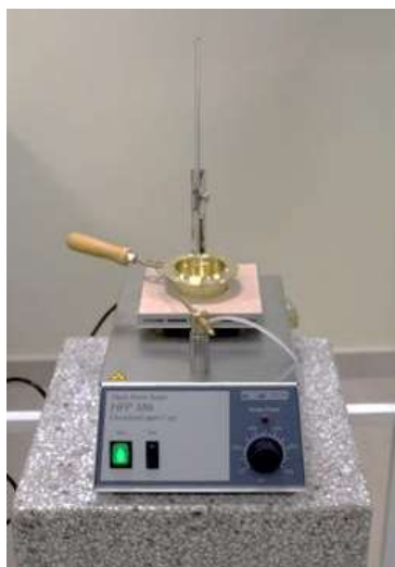
Ryc. 3. Aparat do oznaczania temperatury metodą otwartego tygla Clevelanda w CNBOP-PIB
