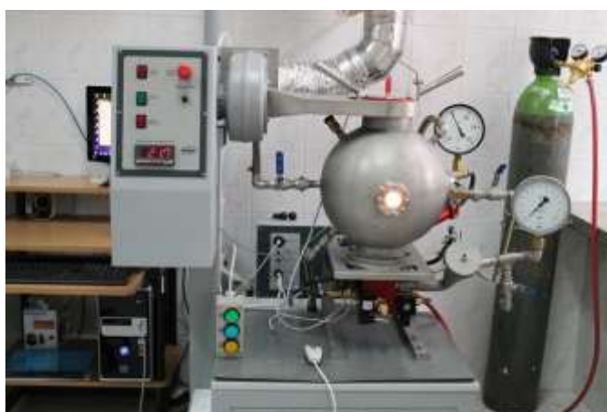
Ryc. 4. Stanowisko do badań zgodnych z normą PN-EN 14034:2011
