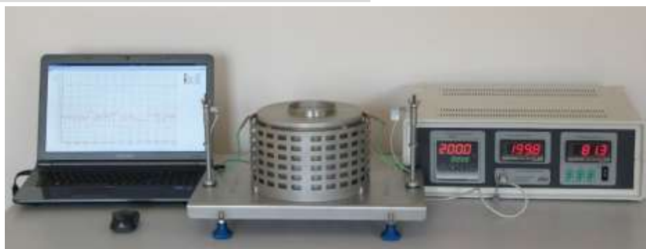
Ryc. 9. Aparatura do oznaczania minimalnej temperatury zapłonu warstwy pyłu wg PN-EN 50281-2-1:2002
