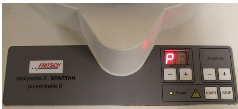
Ryc. 12. Widok na klawiaturę do ustawienia parametrów przesiewania
