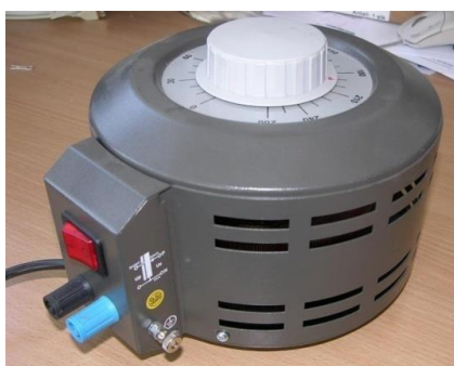
Ryc. 8. Wyposażenie do badania odporności na zapady i zaniki napięcia sieciowego
