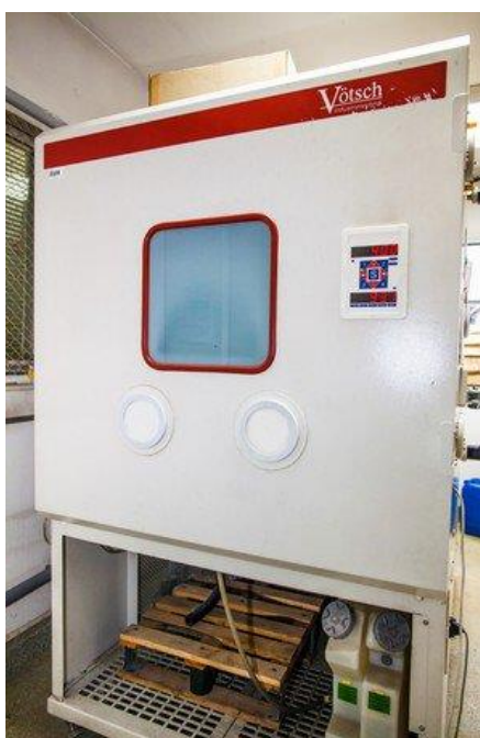
Ryc. 5. Widok komory do badań klimatycznych
