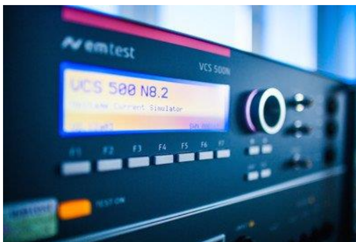
Ryc. 13. Wyposażenie do badania odporności na powolny udar napięciowy o wysokiej energii
