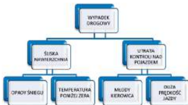
Rys. 6. Przykład analizy drzewa błędów
