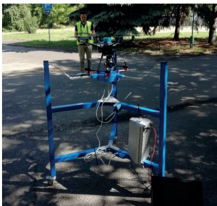
Ryc. 8. Stanowisko Dronesbench oraz urządzenie pomiarowe AirLogger Źródło: opracowanie własne.
