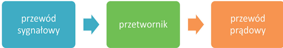
Ryc. 13. Schemat blokowy przekazania sygnału z czujnika do układu akwizycji
