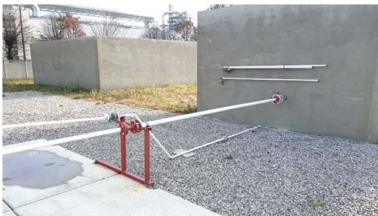
Ryc. 16. Stanowisko do badania pożarów strumieniowych (zakończenie rurociągu z zamontowanym gazomierzem przeznaczonym do pomiaru objętości gazu o natężeniu przepływu do 70 m 3 /h)
