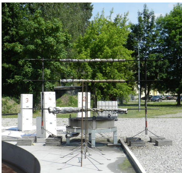
Ryc. 1. Stanowisko do badania pożarów powierzchniowych posadowione na płycie żelbetowej Źródło: opracowanie własne.
