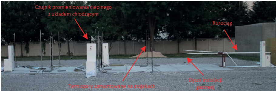
Ryc. 20. Stanowisko pomiarowe do badań pożarów strumieniowych
