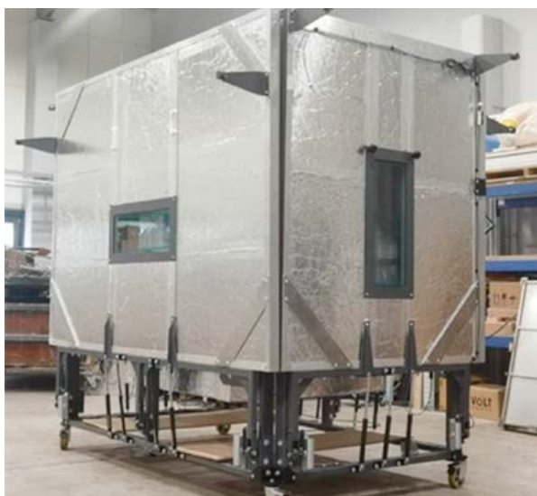
■ Komora grzewcza do wygrzewania akumulatorów
