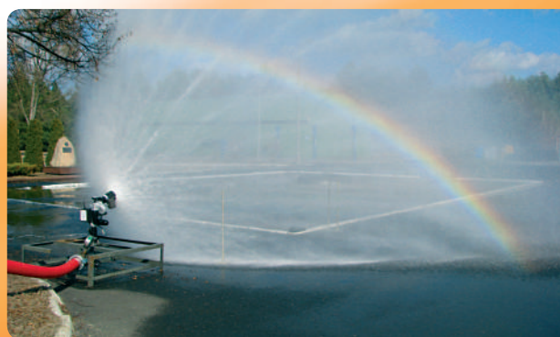
Pomiary parametrów strumienia rozproszonego z działka wodnego, z archiwum CNBOP-PIB
