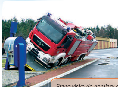
Stanowisko do pomiaru granicznego kąta przechyłu bocznego pojazdów pożarniczych. Fotografia – archiwum CNBOP-PIB
