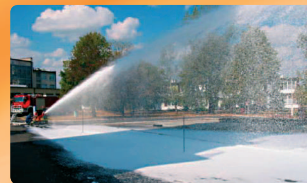
Wyznaczanie zasięgu rzutu strumienia działka wodno-pianowego, z archiwum CNBOP-PIB
