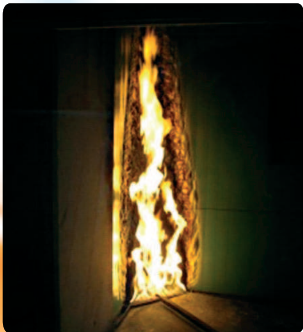
Stanowisko do badania palności materiałów budowlanych SBI
