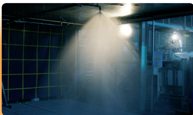
Pomiary parametrów strumienia rozproszonego ze zraszacza, z archiwum CNBOP-PIB
