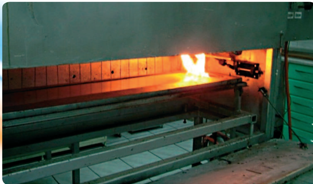
Stanowisko do badania palności materiałów budowlanych - badanie podłóg
