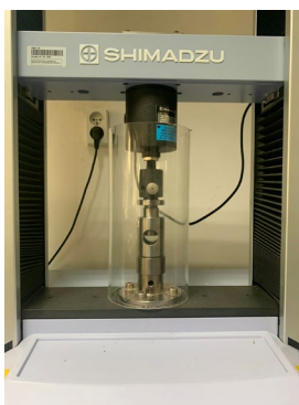
■ Stanowisko do badania wytrzymałości elementów termoczułych – szklanych ampułek tryskaczy
