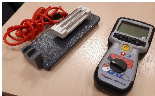
■ Stanowisko do oznaczania rezystywności pyłów wg PN-EN ISO 80079-20
