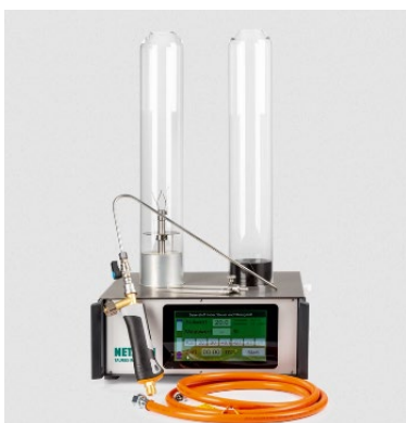
■ Stanowisko do oznaczania indeksu tlenowego [LOI 901] wg ISO 4589-2, ASTM D2863 – do określania palności tworzyw sztucznych na podstawie indeksu tlenowego w temperaturze otoczenia
