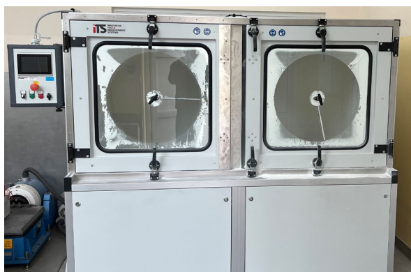
■ Komora kurzowa – stanowisko do badania stopnia ochrony IP
