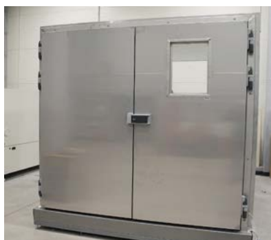
■ Komora klimatyczna wielkogabarytowa prod. KGA INTECH nr J036 o poj. 10 000 litrów
