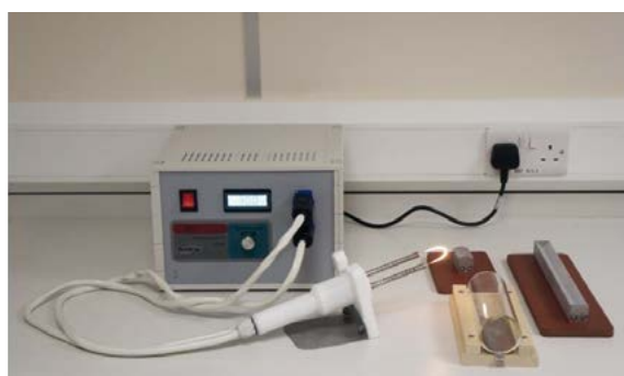
■ Stanowisko Burning Behaviour wg. VDI 2263-1 pkt 1.2.2. b
