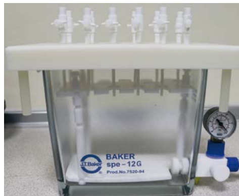
■ Stanowisko do zateżenia i ekstrakcji próbek do fazy stałej metodą SPE
