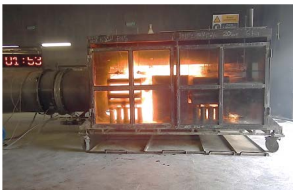
■ Stanowisko służy do badania skuteczności gaśniczej systemu gaśniczego w oparciu o Regulamin nr 107 Europejskiej Komisji Gospodarczej Organizacji Narodów Zjednoczonych [EKG ONZ]
