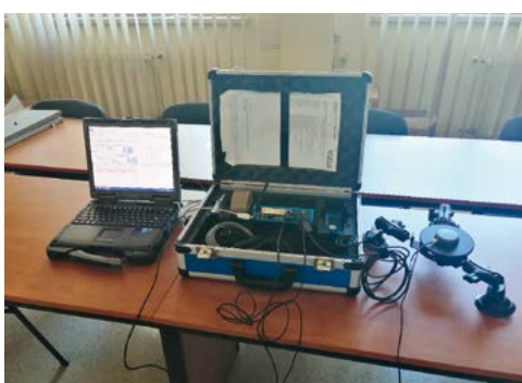
■ Urządzenie VBOX Racelogic do badań dynamicznych pojazdów
