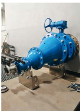
■ Kolektor wodny na stanowisku do badania pomp i armatury wodno-pianowej
