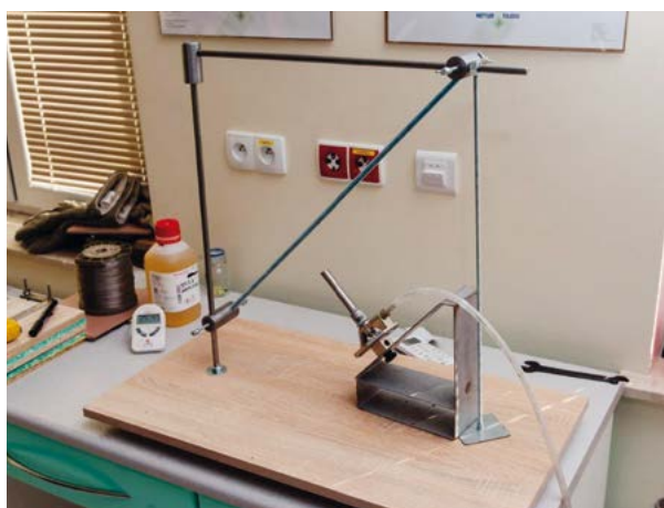
■ Stanowisko do badań odporności na rozprzestrzenianie płomienia po kablach elektrycznych stosowanych wewnątrz pojazdów silnikowych wg Regulaminu nr 118 [EKG ONZ] zał. nr. 10
