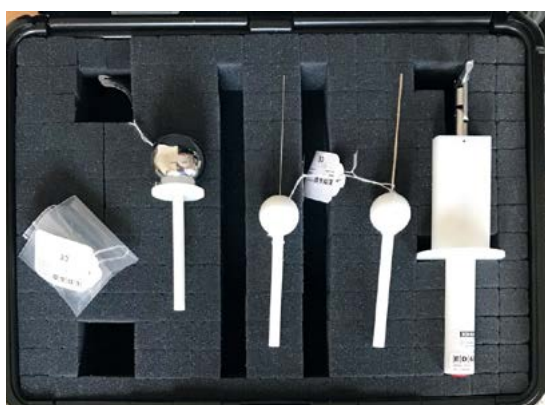
■ Zestaw do badań stopnia ochrony obudowy przed wnikaniem ciał stałych (IP1X; IP2X; IP3X; P4X)
