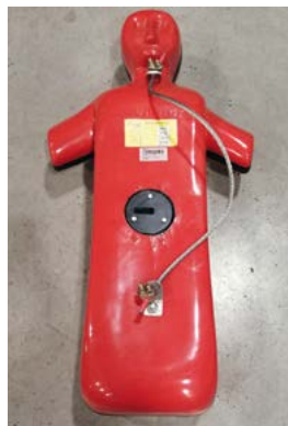
■ Manekin z trzyosiowymi czujnikami przeciążenia do rozbudowy stanowiska do badania skokochronów
