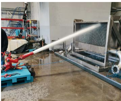
■ Widok badania wstępnego z użyciem zrzutni wody na stanowisku do badania pomp i armatury wodno-pianowej
