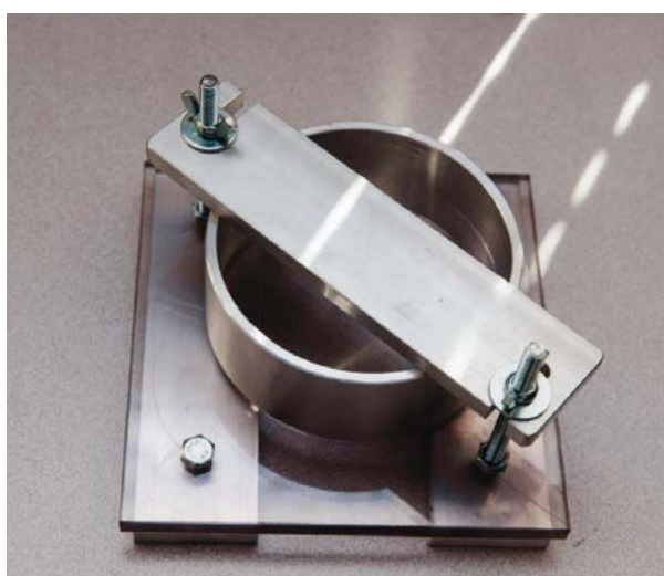
■ Stanowisko do badań określających odporność na pochłanianie paliw i smarów wg Regulaminu nr 118 [EKG ONZ] zał. nr. 9
