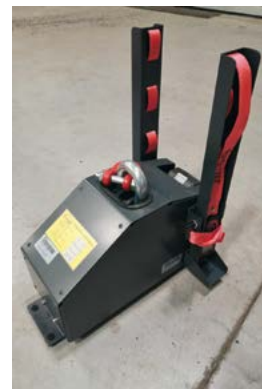
■ Urządzenie zwalniające obciążenie testowe na stanowisku do badania skokochronów
