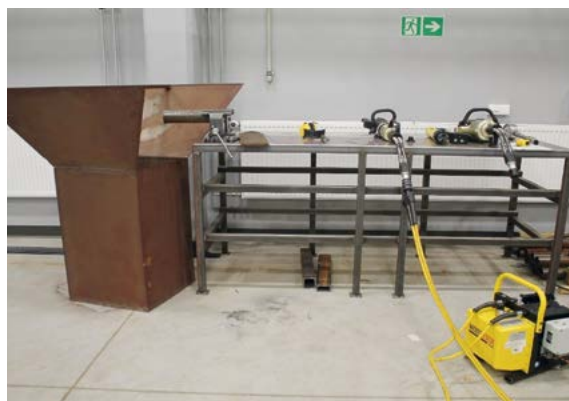
■ Stanowisko do wykonywania pomiarów wymiarów geometrycznych i prób cięcia nożycami hydraulicznymi
