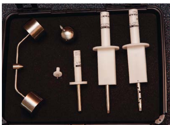
■ Zestaw do badań stopnia ochrony obudowy przed wnikaniem ciał stałych IP
