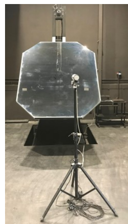
■ Fotogoniometr lustrzany do odczytu właściwości lamp
