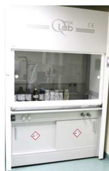
■ Stanowisko do badań chemicznych środków gaśniczych i farb – dygestorium z wyciągiem oparów wykorzystywanych odczynników
