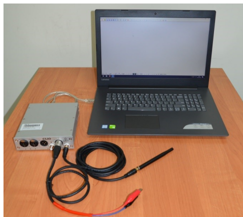
■ Zestaw pomiarowy do automatycznych pomiarów parametrów elektroakustycznych głośników w komorze bezchowej
