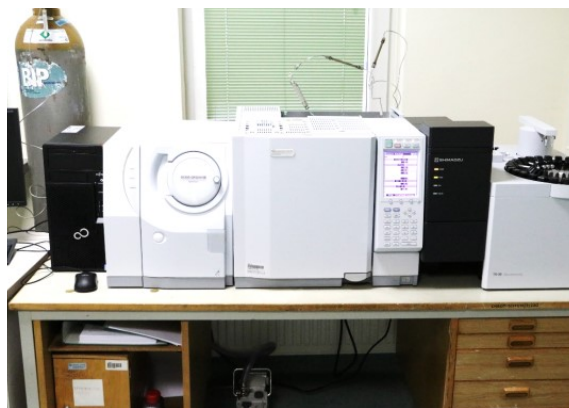
■ Chromatograf gazowy GC-MS do określania składu chemicznego środków gaśniczych
