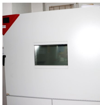
■ Stanowisko do badań klimatycznych podzespołów SUG z regulacją temperatury i wilgotności
