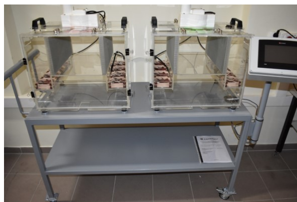
■ Komora gazowa do badania progu zadziałania czujek tlenu węgla
