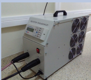
■ Rezystor rozładowczy R200V5 do obciążania linii głośnikowych
