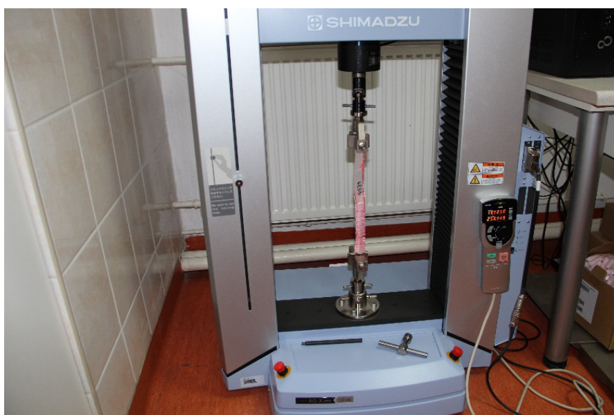
■ Stanowisko do badania wytrzymałości węży na rozwarstwianie (maszyna wytrzymałościowa Shimadzu znajdująca się w BU)
