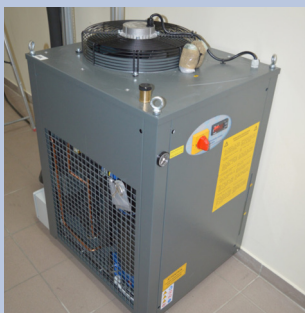
■ Moduł chłodzenia do kanału do badania czujek multidetektorowych
