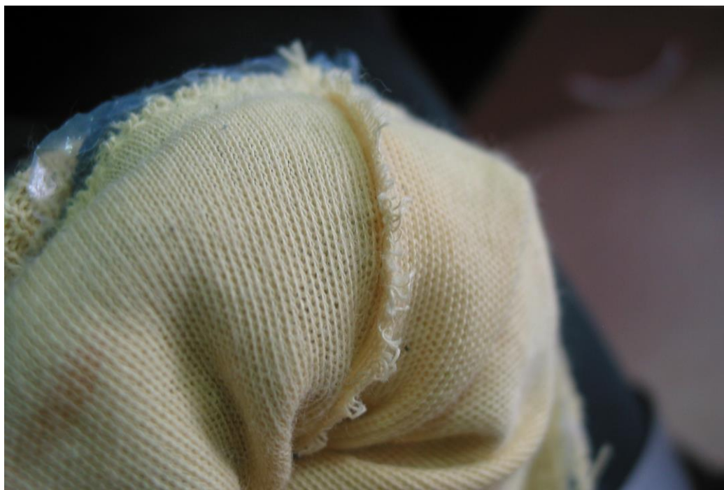
Fot. 3 Prawidłowy układ materiałów w miejscu połączenia podszewki
