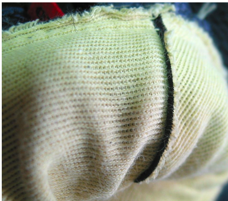
Fot. 4 Nieprawidłowy układ materiałów w miejscu zszycia podszewki
