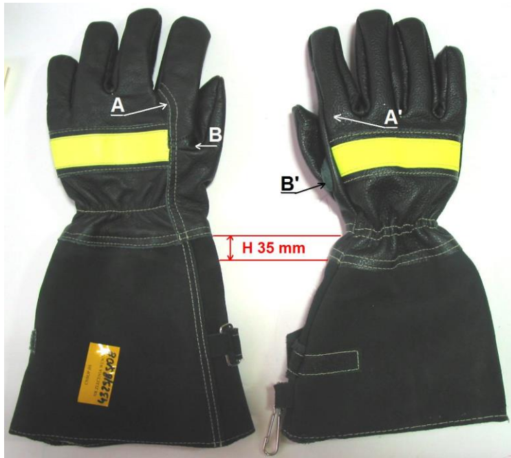
Fot. 11 Widok rękawic wzorcowej (po lewej) i niezgodnej ze wzorem, na który wydano świadectwo dopuszczenia
