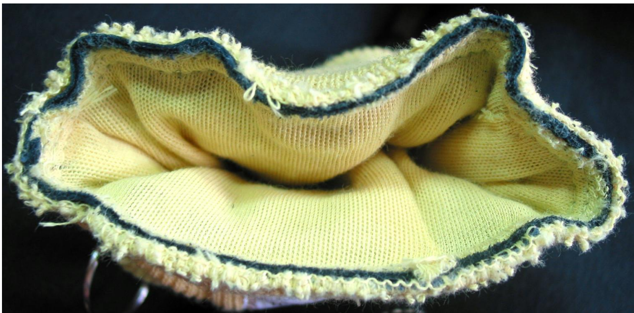
Fot. 10 Brak widocznej membrany mimo jej faktycznego wbudowania w rękawicę
