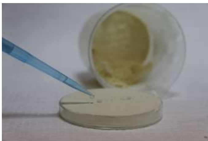
Ryc. 3. Krople wody na powierzchni proszku gaśniczego
