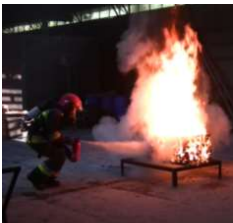
Ryc. 19. Gaszenie pożaru drewna za pomocą gaśnicy proszkowej
