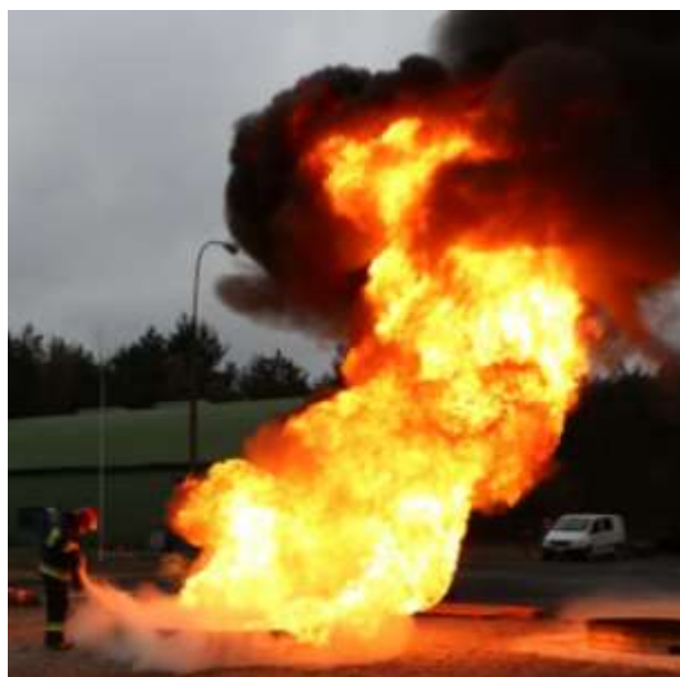
Ryc. 21. Efekt wzmożenia płomienia tuż po pierwszym kontakcie proszku gaśniczego z pożarem
