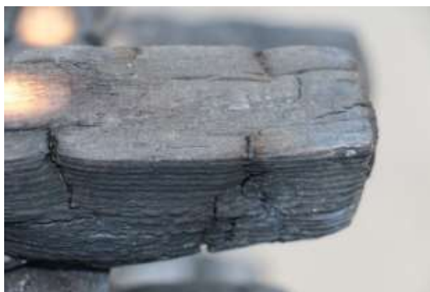
Ryc. 14. Drewno sosnowe po gaszeniu wodą (brak szklistej warstwy izolującej)
