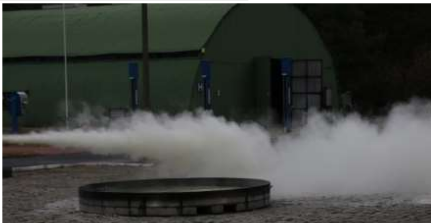
Ryc. 22. Ugaszenie pożaru cieczy za pomocą gaśnicy proszkowej
