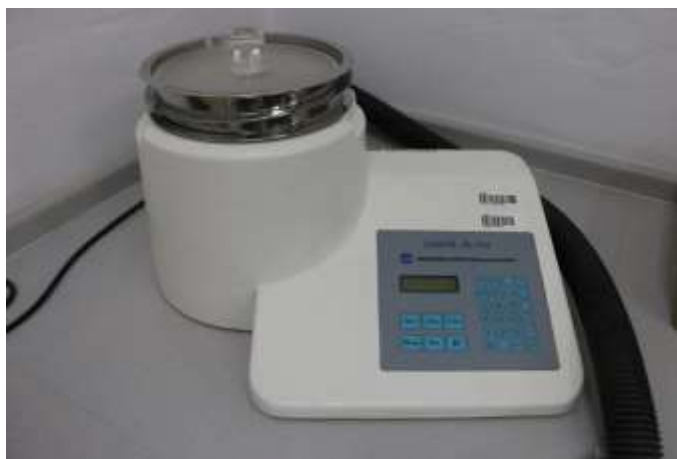
Ryc. 27. Przykład stanowiska do analizy składu ziarnowego proszków gaśniczych
