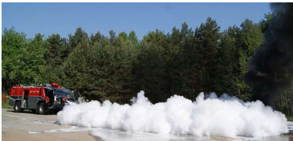
Ryc. 17. Samochód pożarniczy podczas gaszenia proszkiem rozlewiska cieczy palnej
