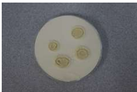
Ryc. 28. Krople wody wchłonięte przez proszek gaśniczy
