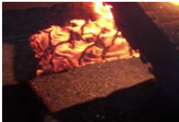
Ryc. 10. Spalanie bezpłomieniowe drewna sosnowego z emisją światła ze strefy spalania
