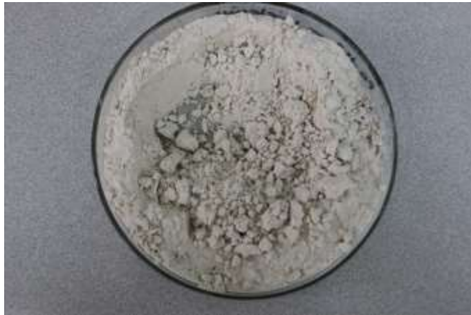
Ryc. 5. Próbkę proszku gaśniczego, która uległa zbryleniu
