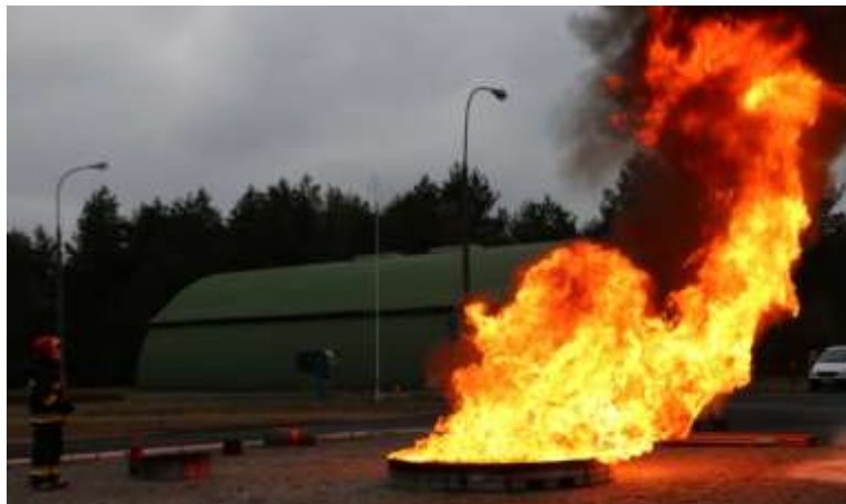
Ryc. 20. Rozwinięty pożar cieczy palnej - operator od strony zawietrznej
