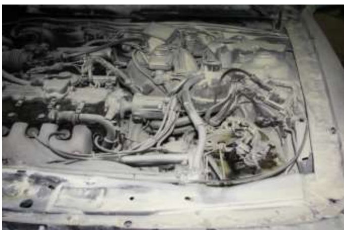
Ryc. 7. Komora silnika po użyciu gaśnicy proszkowej
