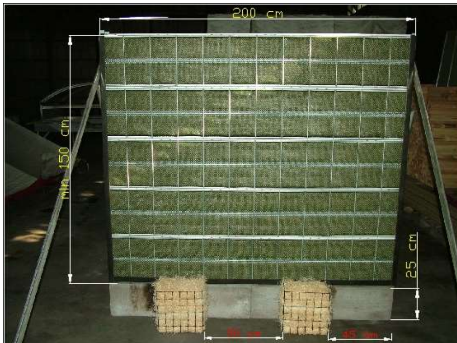
Ryc. 1. Stanowisko badawcze do badania ekranu akustycznego z zamocowaną próbką (ekran typu zielona ściana) zgodnie z wymaganiami PN-EN 1794-2:2011
