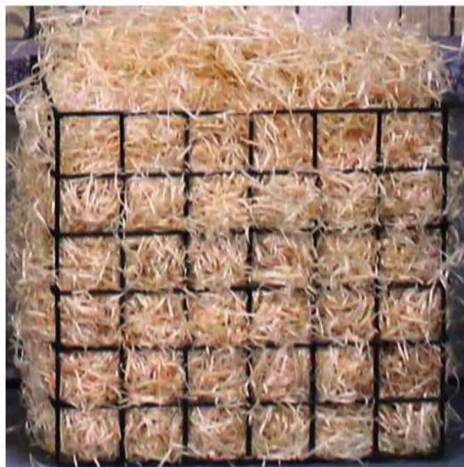
Ryc. 2. Prostopadłościenny kosz wypełniony strużynami zgodnie z wymaganiami PN-EN 1794-2:2011
