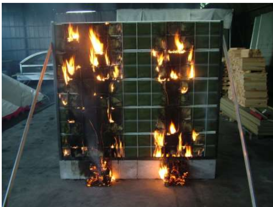
Ryc. 4. Badanie ekranu przeciwhałasowego zgodnie z wymaganiami PN-EN 1794-2
