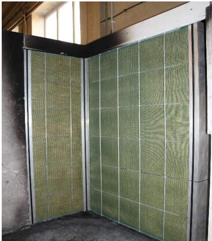
Ryc. 6. Komora badawcza stanowiska badawczego wg PN-EN 13823
