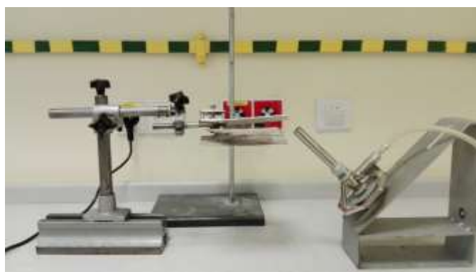
Ryc. 6. Sposób zamocowania próbki oraz ustawienia palnika pod kątem 45°
