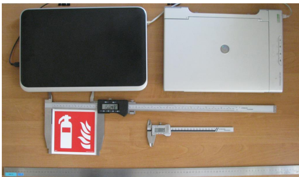
Ryc. 1. Mobilne stanowisko weryfikacji wielkości i porównania symbolu graficznego znaku bezpieczeństwa ze wzorcem
