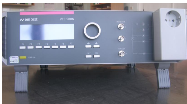
Ryc. 8. Wyposażenie do badania odporności na zapady i zaniki napięcia sieciowego
