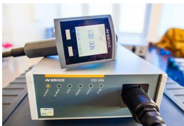
Ryc. 9. Wyposażenie do badania odporności na wyładowania elektrostatyczne
