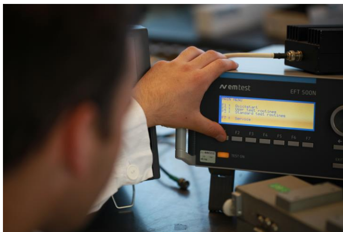
Ryc. 12. Wyposażenie do badania odporności na serie elektrycznych stanów przejściowych
