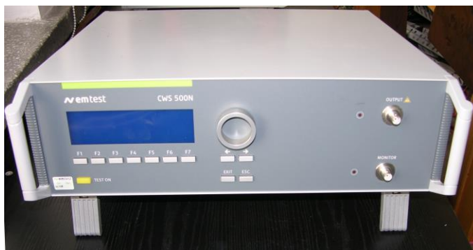
Ryc. 11. Wyposażenie do badania odporności na zaburzenia przewodzone indukowane przez pola elektromagnetyczne
