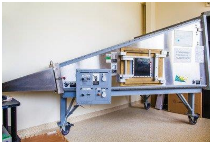
Ryc. 10. Wyposażenie do badania odporności na wypromieniowane pola elektromagnetyczne
