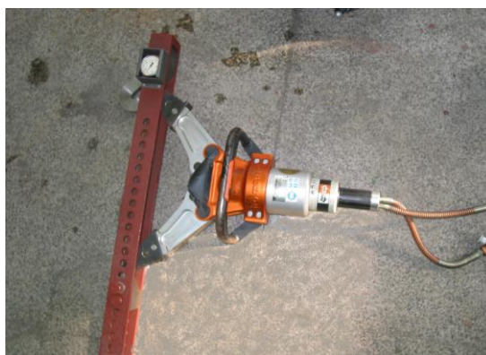
Ryc. 23. Próba siłowa przy zmienionej rozwarości ramion roboczych rozpieracza Źródło: opracowanie własne
