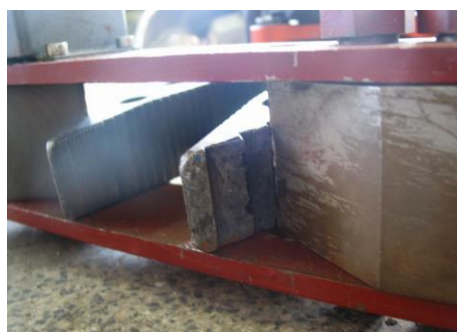
Ryc. 19. Ustawienie końcówek roboczych w ramie pomiarowej
