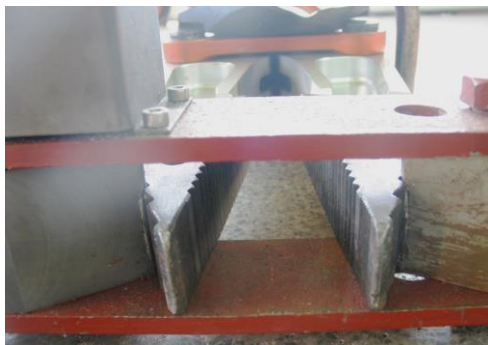
Ryc. 20. Ustawienie końcówek roboczych w ramie pomiarowej
