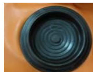
Ryc. 7. Połączenie rozłączne – zawór wydechowy
