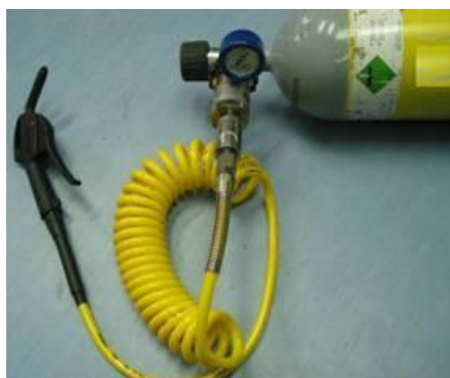
Ryc. 4. Przykładowy system napełniania powietrzem
