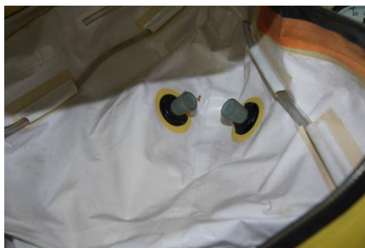
Ryc. 17. Uszczelnione zawory wydechowe Źródło: opracowanie własne
