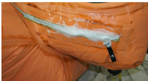
Ryc. 33. Zamek gazoszczelny prawidłowo uszczelniony Źródło: opracowanie własne
