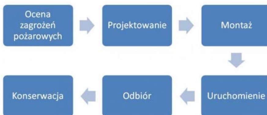
Ryc. 12. Zakres czynności towarzyszących procesowi wytwarzania i/lub utrzymania SSP, które można objąć certyfikacją 18
