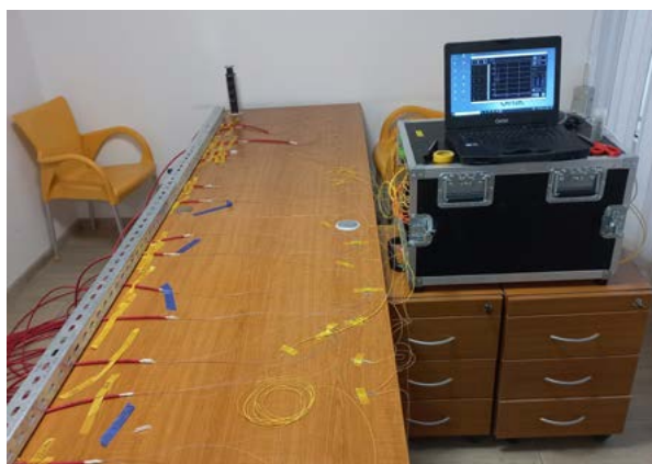
■ Stanowisko do badania tłumienności światłowodów (w trakcie badania kabli światłowodowych)
