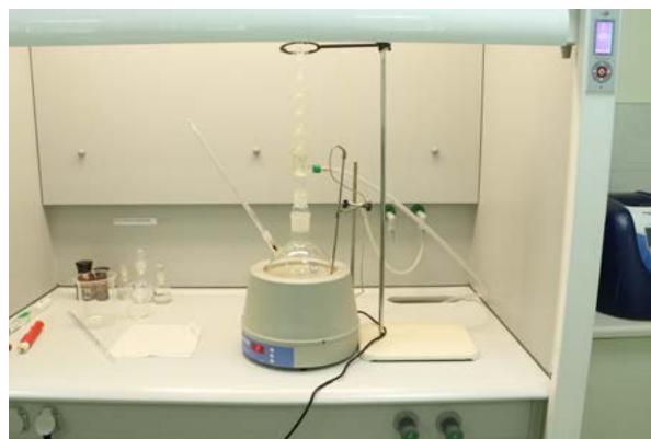
■ Stanowisko do badania korozji we wrzącym chlorku magnezu
