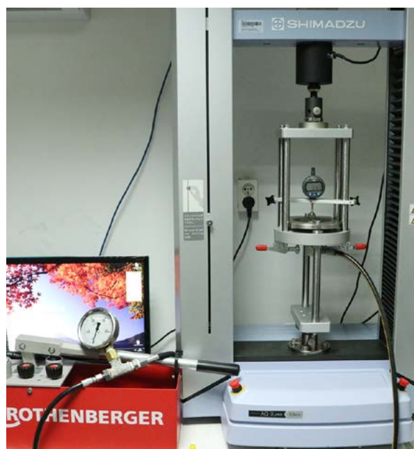
■ Stanowisko do rozciągania tryskaczy wg normy PN-EN 12259-1
