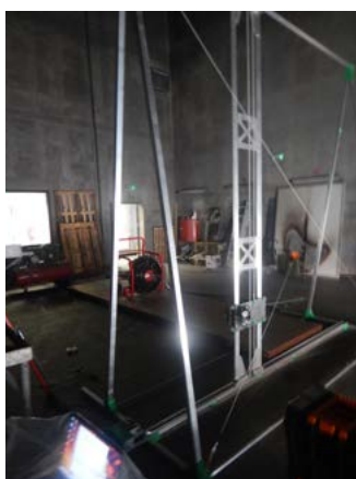
■ Stanowisko badawcze do badania strugi powietrza wytwarzanej przez mobilne wentylatory
