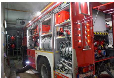
Rysunek 9. Widok pojazdu w komorze klimatycznej w trakcie sprawdzeń funkcjonowania układu wodno-pianowego oraz wyposażenia zabudowy
