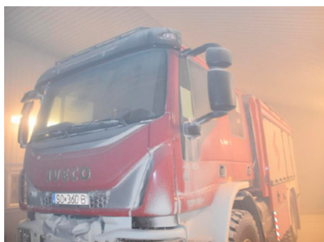
Rysunek 10. Widok pojazdu podczas badań odporności na pył
