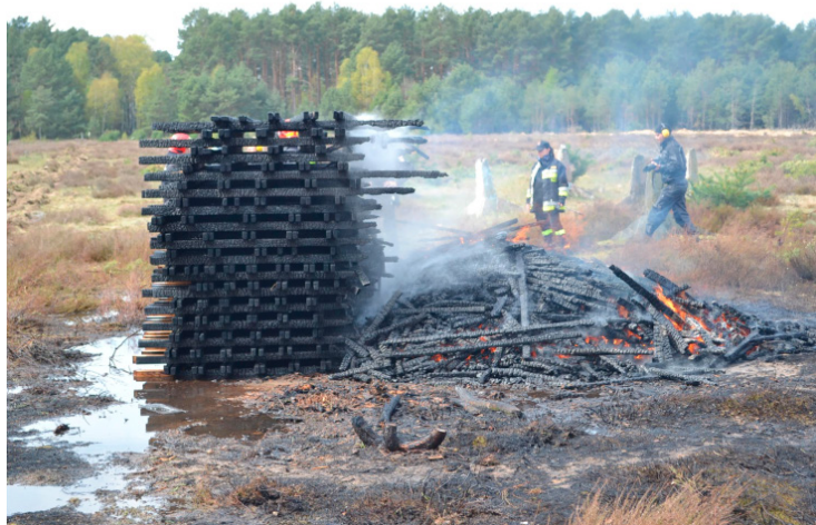
Rysunek 10. Efekt gaszenia turbiną pożaru grupy A. Połowa stosu została obroniona. Druga połowa uległa spaleniu. Zdjęcie własne autorów
