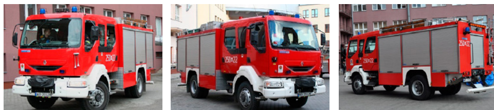
Rysunek 2. Średni samochód ratowniczo-gaśniczy na podwoziu Renault Midlum 220.14 Źródło: opracowanie własne
