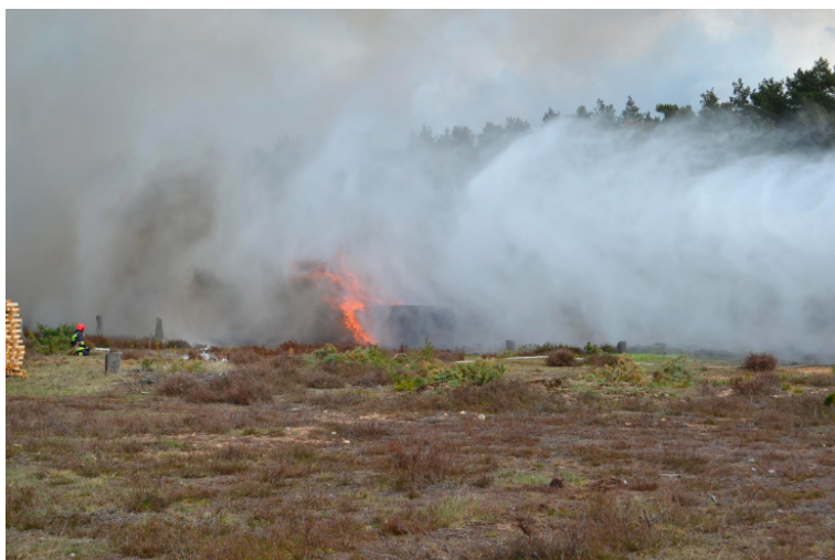
Rysunek 9. Gaszenie turbiną pożaru grupy A. Stos drewna o wymiarach 3,6×3,6 m składający się z 26 warstw. Ilość palącego się drewna 7,5 m 3 . Zdjęcie własne autorów Figure 9. Extinguishing a Group A Fire with turbine. A stack of 3.6x3.6 wood consisting of 26 layers. The amount of burning wood is 7.5 m 3
