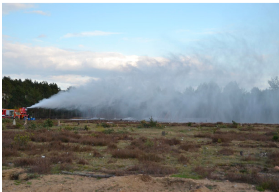
Rysunek 4. Prąd wody działka rozpraszany przez gazy wylotowe turbiny SO 3 . Fot. Bernard Król Figure 4. Water stream from dispersed by exhaust turbine SO 3 gases. Phot. Bernard Król
