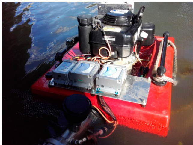
Rysunek 5. Elementy systemu zamocowane na motopompie Niagara 1 KZWM Ogniochron Źródło: opracowanie własne
