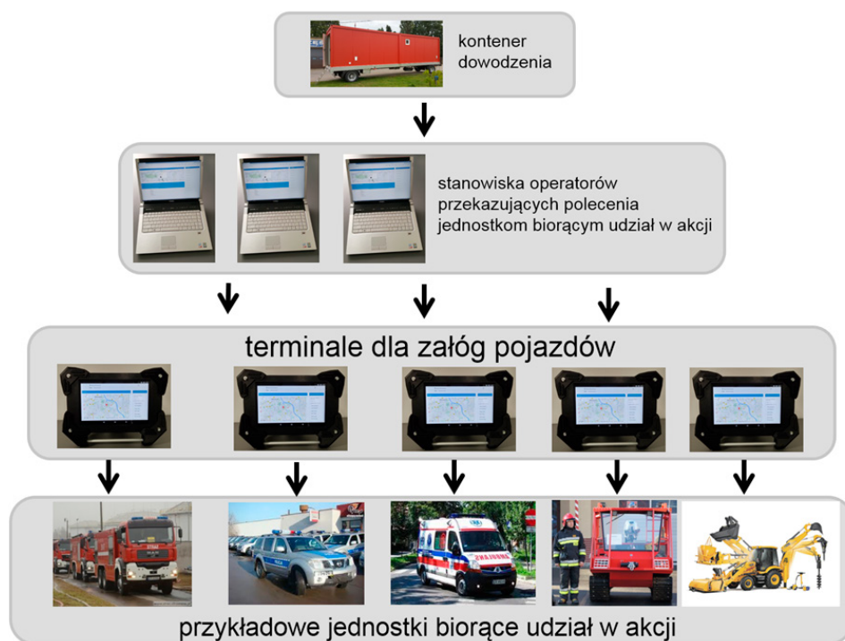
Rysunek 12. Struktura systemu w powiązaniu z używanym sprzętem
