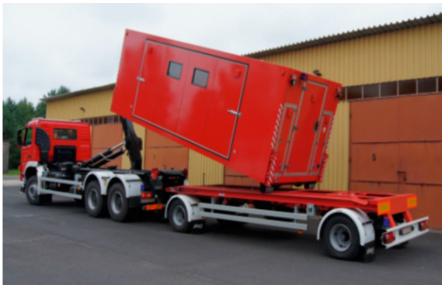
Rysunek 12. Przykład nośnika kontenerów – samochodu i przyczepy
