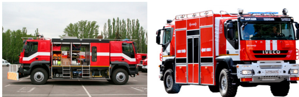
Rysunek 4. Samochody ratowniczo-gaśnicze: PSA-T-3,0-40/4 i PSA-Cz-20 do prac w tunelach komunikacyjnych
