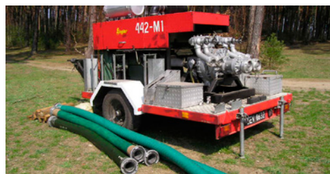
Rysunek 6. Motopompa M48/8 wraz z węzami ssawnymi o długości 2,4 [m] i 4,0 [m] Figure 6. Motor pump M48/8 with 2,4 and 4 [m] suck hoses
