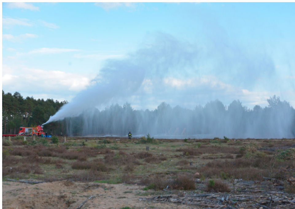
Rysunek 14. Praca demonstratora przy wysokim kącie podawania umożliwia likwidację chmur chemicznych oraz działania chłodzące w obronie. Zdjęcie własne autorów Figure 14. The work of the system demonstrator at a high monitor angle enables liquidation of chemical clouds and cooling actions in defense
