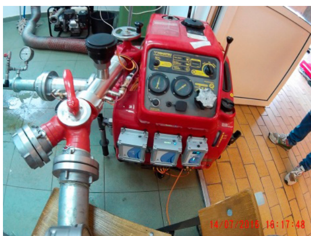
Rysunek 4. Elementy systemu zamocowane na motopompie Tohatsu VC72AS Źródło: opracowanie własne
