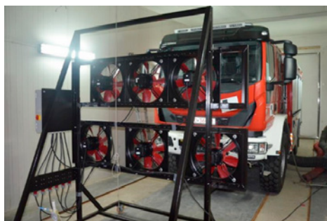
Rysunek 8. Widok pojazdu w komorze klimatycznej w trakcie badań skuteczności układu wentylacji
