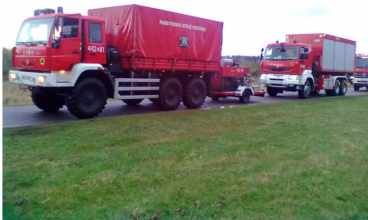
Rysunek 9. Sekcja pompowo-wężowa kompanii gaśniczej WBO składająca się z zastępu kwatermistrzowskiego SCKw przewożącego zbiornik do magazynowania wody do celów gaśniczych o pojemności 50 \text{ m}^3 wraz z motopompą M80/8 oraz nośnik kontenerowy z modułem wężowym do przewożenia 150 szt. węży tłocznych W 110 (zasięg taktyczny sekcji 3000 [m]) Figure 9. Pumping and hose section of the WBO firefighting company consisting of a quartermaster unit SCKw carrying a water storage tank for 50 \text{ m}^3 with motor pump M80/8 and a container carrier with a hose module for carrying 150 feeding hoses W 110 (tactical range of section 3000 [m])
