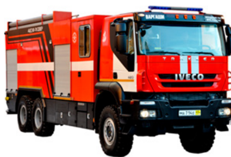
Rysunek 3. Samochód gaśniczy AC-S 8, 0-70 w wykonaniu klimatycznym Chł. Figure 3. Firefighting vehicle AC-S 8,0-70 in cold climate configuration
