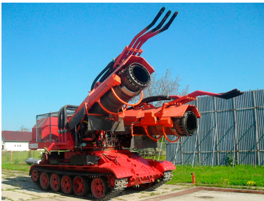
Rysunek 1. Pojazd turbinowy węgierskiej produkcji zabudowany na podwoziu czołgowym T34, wyposażony w dwie turbiny myśliwca MIG-21 [6]
