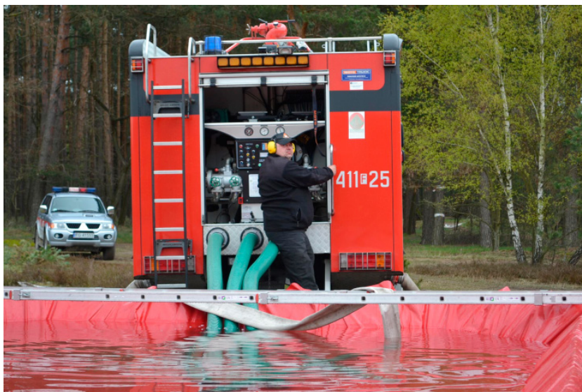
Rysunek 6. Zasilanie pośrednie poprzez GCBA ze zbiornikiem o pojemności 5 m 3 posiadającym pompę o wydajności 6000 dm 3 /min (pompa Zieglera FPM 10-6000). Zdjęcie własne autorów Figure 6. Indirect water supply through GCBA with a 5 m 3 capacity tank having a pump with a yield of 6000 dm 3 /min (Ziegler FPM 10-6000 pump)
