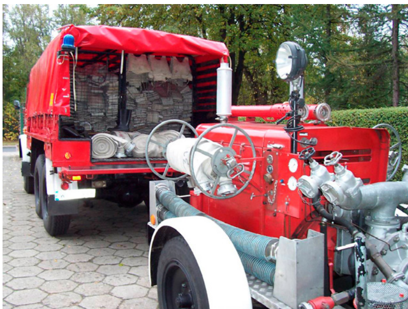
Rysunek 8. Zastęp SW 5000 wraz z motopompą M48/8 – powszechne rozwiązanie techniczno-organizacyjne w latach 80 i 90 XX wieku – konstrukcja o optymalnych parametrach taktyczno-technicznych
