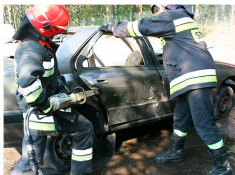
Rysunek 10 i 11. Uwalnianie poszkodowanych przy użyciu narzędzi hydraulicznych podczas testowania systemu
