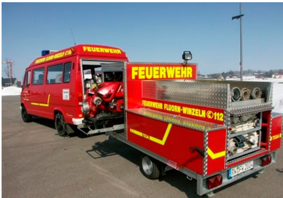
Rysunek 2. Moduł wsparcia działań gaśniczych (MWDG)
