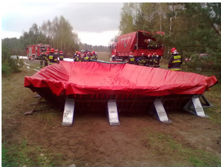
Rysunek 10. Zbiornik składany do magazynowania wody do celów gaśniczych o pojemności 50 \text{ m}^3 Figure 10. Folding tank for storage of water for extinguishing purposes with a capacity 50 \text{ m}^3
