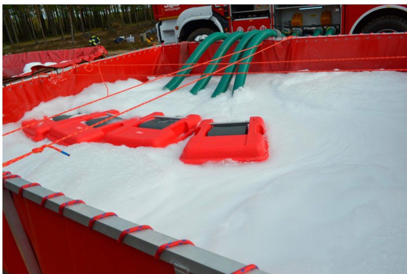
Rysunek 7. Zasilanie demonstratora realizowane poprzez 4 smoki ssawne pływające. Zdjęcie własne autorów Figure 7. Demonstrator water supply by 4 swimming suction
