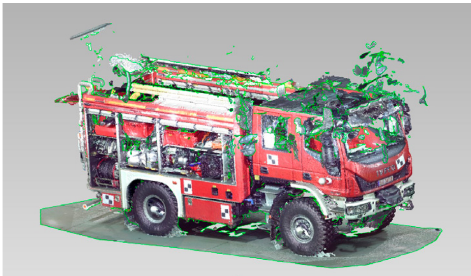
Rysunek 1. Widok modelu 3D zeskanowanego pojazdu pożarniczego
