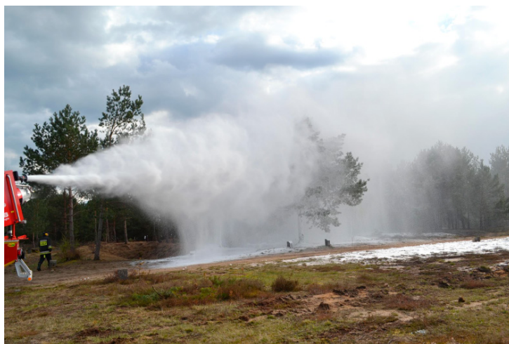
Rysunek 11. Podawanie prądu gaśniczego turbiny na wierzchołki drzew. 3-proc. roztwór środka pianotwórczego typu S Protektol SAT-10. Zdjęcie własne autorów
