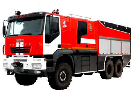
Rysunek 2. Samochód ratowniczo-gaśniczy PSA-S6,0-40 w wykonaniu klimatycznym Chł. Figure 2. Fire/rescue vehicle PSA-S6, 0-40 (6339) in cold in cold climate configuration
