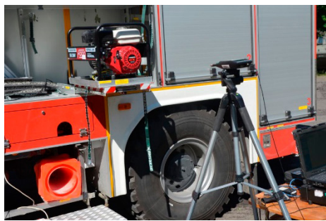
Rysunek 13. Widok rozmieszczenia urządzenia pomiarowego w trakcie pomiarów poziomu natężenia dźwięku agregatu prądotwórczego
