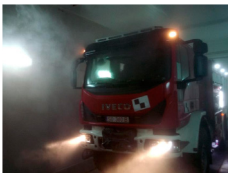
Rysunek 11. Widok pojazdu podczas badań odporności na zwiększoną wilgotność
