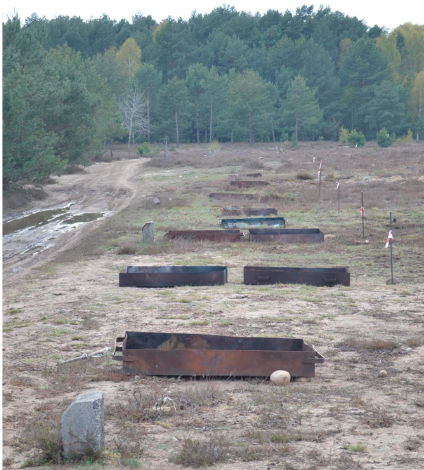
Rysunek 13. Rozstawienie wanien 1x1,5 do testu dla pożarów grupy B widziane od strony demonstratora systemu. Zdjęcie własne autorów
