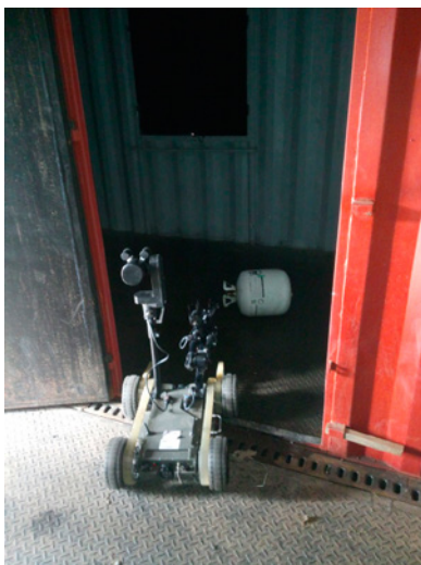
Rysunek 5. Mobilny robot „PIAP Scout” – podnoszenie atrapy butli z gazem propan-butan Źródło: T. Drzymała, Sprawozdanie z zadania badawczego III.17.1.1.1 „Testowanie i demonstracja platformy sprzętowej” . Warszawa 2017
