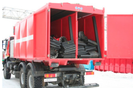
Kontener węzowy Hose storage container
