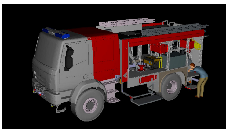
Rysunek 6. Widok podczas symulacji pobierania wyposażenia z pojazdu, wykorzystano model z oprogramowania CAD
