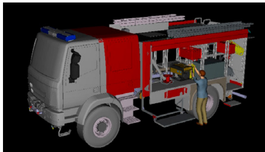
Rysunek 7. Widok podczas symulacji pobierania wyposażenia z pojazdu, wykorzystano model z oprogramowania CAD
