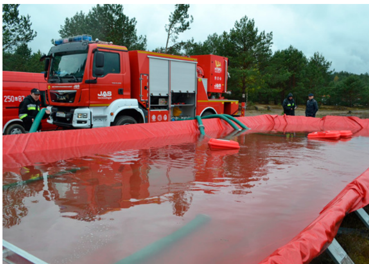
Rysunek 15. Zbiornik rozkładany o pojemności 50 m 3 będący na wyposażeniu KW PSP w Gorzowie Wielkopolskim. Czas rozkładania 20–30 minut. Zdjęcie własne autorów Figure 15. Folding tank (capacity of 50 m 3 ), owned by the State Fire Service Gorzów Wielkopolski. Preparating time 20–30 minutes
