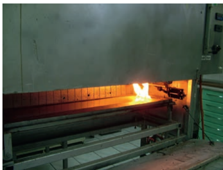
Ryc. 32. Stanowisko badawcze wg. PN-EN ISO 9239-1 stosowane w Zespole Laboratoriów Procesów Spalania i Wybuchowości CNBOP-PIB
