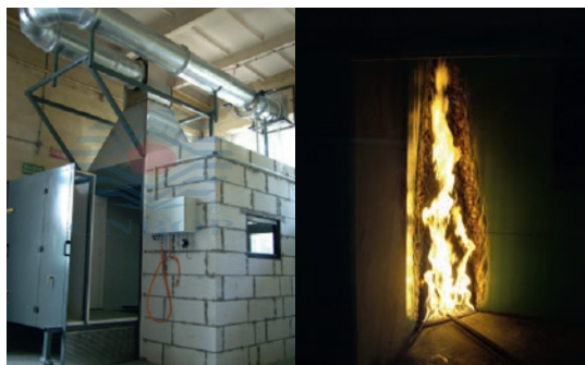
Ryc. 30. Stanowisko badawcze wg PN-EN 13823, stosowane w Zespole Laboratoriów Procesów Spalania i Wybuchowości CNBOP-PIB
