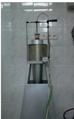
Ryc. 28. Stanowisko do badania niepalności, stosowane w Zespole Laboratoriów Procesów Spalania i Wybuchowości CNBOP-PIB
