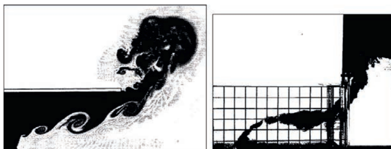
Ryc. 18. Symulacja numeryczna (lewy) i eksperyment (prawy) przepływu słonej wody
