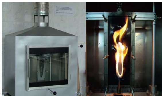
Ryc. 31. Stanowisko badawcze wg PN-EN ISO 11925-2 stosowane w Zespole Laboratoriów Procesów Spalania i Wybuchowości CNBOP-PIB
