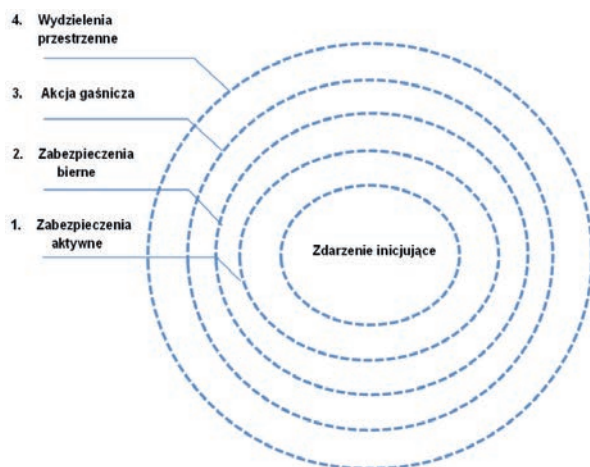
Ryc. 5. Warstwy zabezpieczeń w scenariuszach zdarzeń
