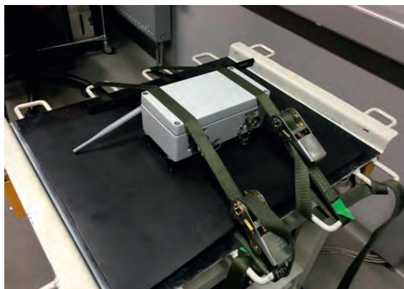
Rysunek 5. Moduł Komunikacji – testy wibracyjne [3]
