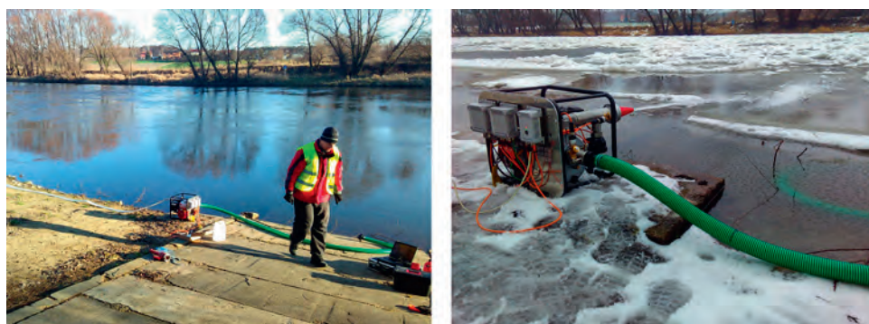
Rysunek 7. Testy pompy półszlamowej Honda SST50 prowadzone nad rzeką Wartą w jesiennych i zimowych warunkach
