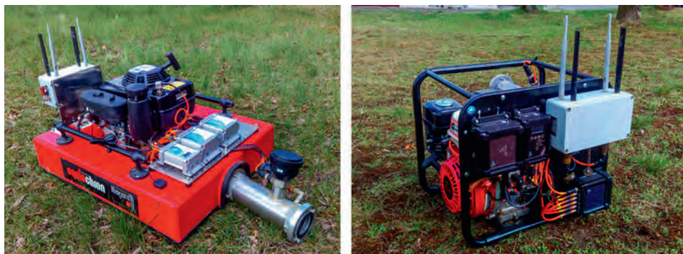
Rysunek 1. Dwa przykładowe urządzenia na których został zainstalowany system: pompa pływająca Niagara 1 (po lewej) i pompa półszlamowa Honda SST50 (po prawej) Źródło: opracowanie własne
