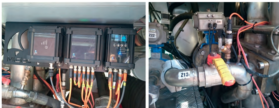
Rysunek 1. Elementy systemu monitorowania zamontowane w pojeździe Renault-Midlum 220.14
