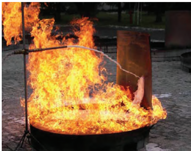
Ryc. 56. Badanie skuteczności pianotwórczej pianotwórczych środków gaśniczych zgodnie z PN-EN 1568-3 (podawanie łagodne)
