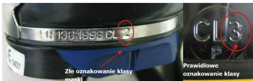
Ryc. 70. Nieprawidłowe znakowanie klasy maski: po lewej znakowanie maski niewłaściwej klasy (CL 2 zamiast CL3), po prawej znakowanie maski właściwej klasy (CL3)
