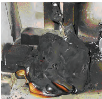
Ryc. 144. Palący się głośnik do DSO, który oderwał się od konstrukcji. Defekt uszkodził linię głośnikową, stwarzając zagrożenie dla użytkowników obiektu i/lub ratowników
