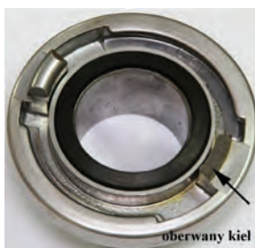
Ryc. 93. Niezgodność – oberwany kiel przy nieprawidłowej wartości ciśnienia może uszkodzić urządzenie w czasie pracy
