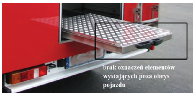
Ryc. 102. Brak oznaczeń elementów wystających poza obrys pojazdu pożarniczego może spowodować wypadek, jeżeli akcja jest prowadzona przy ograniczonej widoczności, np. w nocy
