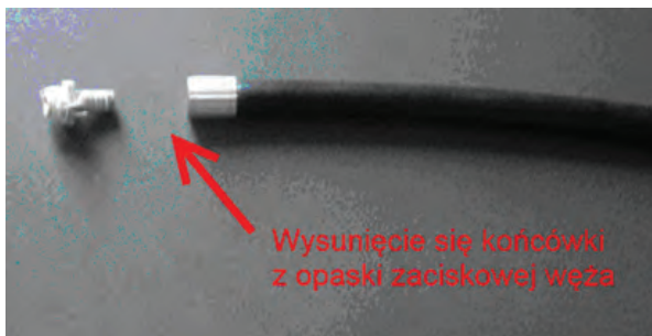
Ryc. 137. Defekt w zespole węża i łącznika, który mógłby spowodować uraz mechaniczny użytkownika
