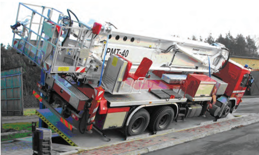
Ryc. 53. Stanowisko do badania kąta przechyłu bocznego pojazdów pożarniczych
