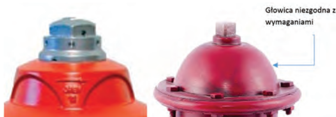
Ryc. 97. Niezgodność – po lewej pokrętło wykonane poprawnie, po prawej głowica pod klucz wykonana niezgodnie z PN: brak kompatybilności z kluczem
