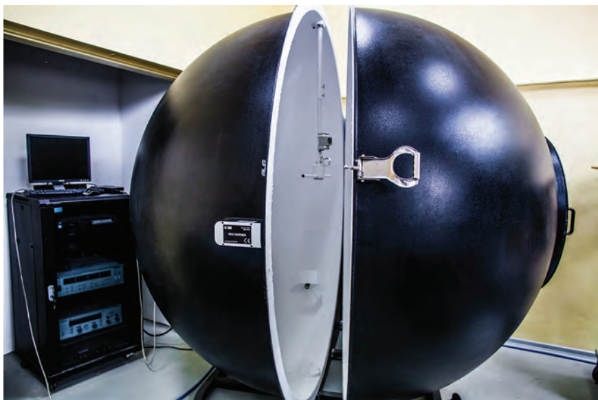
Ryc. 63. Widok stanowiska do badań strumienia świetlnego opraw oświetleniowych do oświetlenia awaryjnego (kula Ulbrichta)
