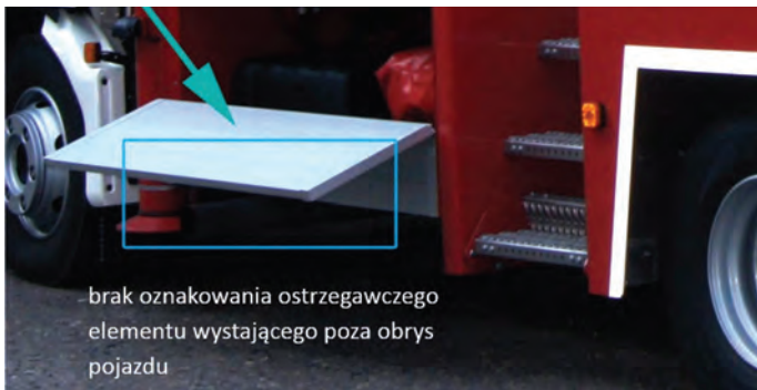
Ryc. 101. Niezgodność – brak oznakowania ostrzegawczego elementu wystającego poza obrys pojazdu pożarniczego
