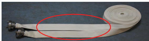
Ryc. 87. Pożarniczy wąż tłoczny do hydrantów – na obu końcach brak znakowania węża
