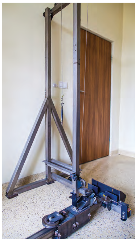
Ryc. 61. Stanowisko do badań parametrów siłowników (badanie polega na sprawdzeniu czasu wysuwu i dopuszczalnego obciążenia)
