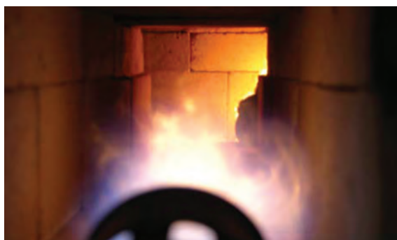
Ryc. 59. Wnętrze pieca badawczego podczas badania odporności głośnika do DSO na działanie wysokiej temperatury (badanie w piecu badawczym, warunki: temperatura 450°C, czas 30 min)
