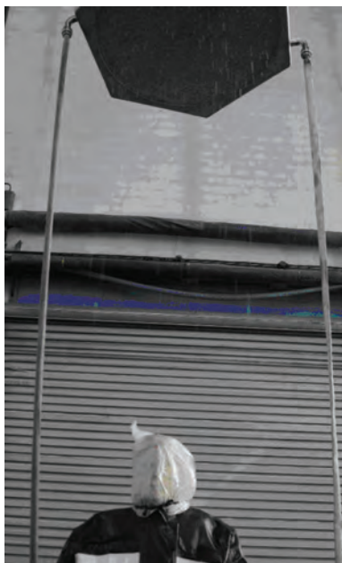
Ryc. 40. Stanowisko do badania ubrań specjalnych na przekamanie metodą B
