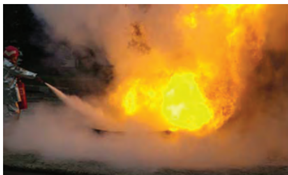
Ryc. 54. Badanie skuteczności gaśniczej gaśnic przenośnych w zakresie pożarów, kolejno: grupy A i B
