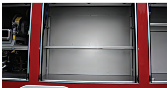
Ryc. 111. Niezgodność – brak wentylacji, odprowadzenia wody i elementów mocujących sprzęt
