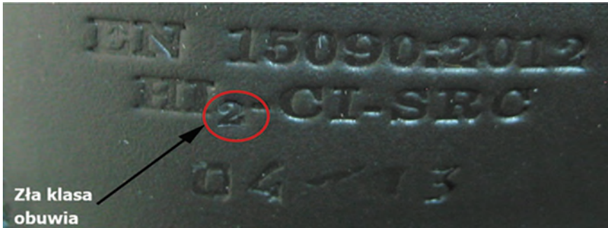
Ryc. 81. Niezgodność – nieprawidłowy poziom skuteczności ochrony (HI2 zamiast HI3): niespełniony wymóg odporności cieplnej podeszwy
