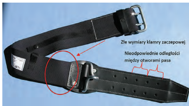
Ryc. 72. Niezgodność – nieodpowiednie wymiary klamry zaczepowej i złe odległości pomiędzy otworami na pasie
