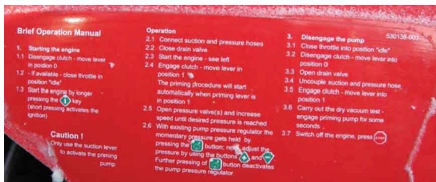
Ryc. 119. Brak skróconej instrukcji w języku polskim (zamieszczono instrukcję w języku niemieckim i angielskim) utrudnia obsługę urządzenia
