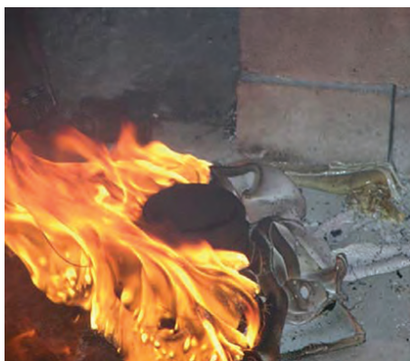
Ryc. 144. Palący się głośnik do DSO, który oderwał się od konstrukcji. Defekt uszkodził linię głośnikową, stwarzając zagrożenie dla użytkowników obiektu i/lub ratowników
