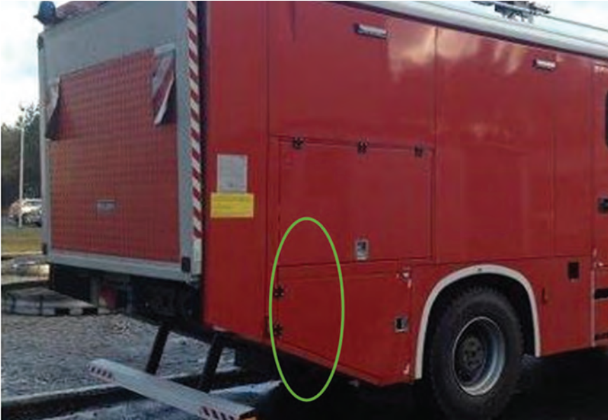
Ryc. 127. Drzwi boczne zawiasowe, pod którymi kryje się pulpit sterowniczy windy załadawczej, zamontowane tak, że ograniczają pole widzenia zasięgu pracy windy – zagrożenie przygnieceniem człowieka lub sprzętu
