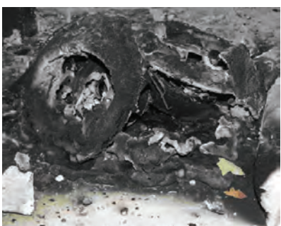
Ryc. 145. Spalony głośnik do DSO, który oderwał się od konstrukcji. Defekt uszkodził linię głośnikową, stwarzając zagrożenie dla użytkowników obiektu i/lub ratowników
