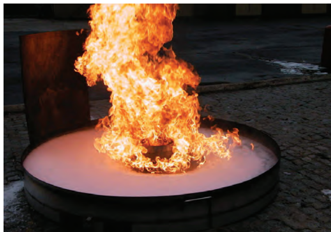
Ryc. 57. Badanie odporności pianotwórczych środków gaśniczych na nawrót palenia zgodnie z PN-EN 1568-3
