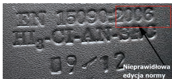
Ryc. 153. Nieprawidłowe znakowanie obuwia strażackiego – oznakowanie powołuje się na nieaktualną normę
