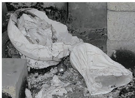
Ryc. 145. Spalony głośnik do DSO, który oderwał się od konstrukcji. Defekt uszkodził linię głośnikową, stwarzając zagrożenie dla użytkowników obiektu i/lub ratowników
