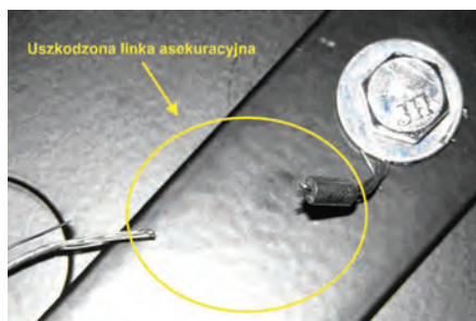
Ryc. 147. Linka asekuracyjna, uszkodzona podczas badania głośnika do DSO z powodu dobrania średnicy linki nieproporcjonalnie do ciężaru głośnika.
