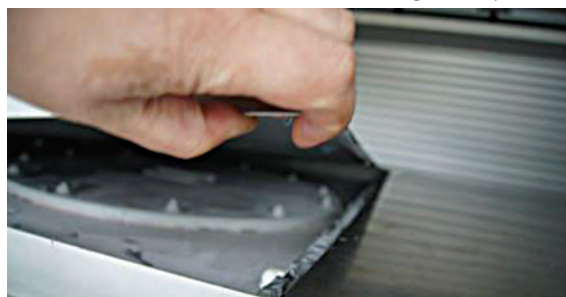
Ryc. 121. Nietrwale połączenia elementów zabudowy – zagrożenie w trakcie użytkowania przy obsłudze sprzętu ratowniczego przewożonego na pojeździe
