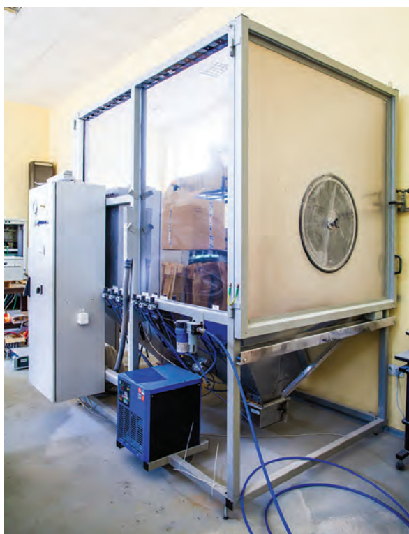
Ryc. 64. Widok komory pyłowej – stanowiska do badań stopnia ochrony obudowy IP
