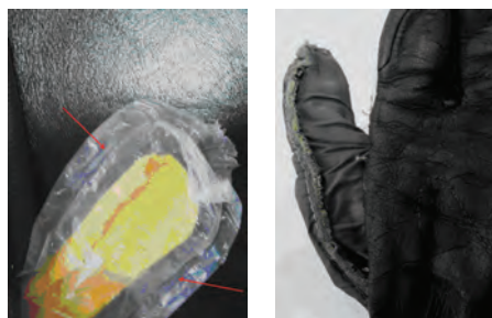
Ryc. 76. Przykład prawidłowo wykonanej rękawicy (po lewej) oraz rękawicy bez wodoszczelnej, paroprzepuszczalnej membrany
