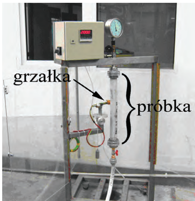
Ryc. 47. Stanowisko do badania odporności na gorącą powierzchnię węży tłocznych do hydrantów
