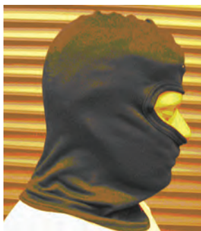
Ryc. 80. Kominiarka niezgodna ze wzorem: zbyt mała odległość od podbródka do dolnej krawędzi kominiarki
