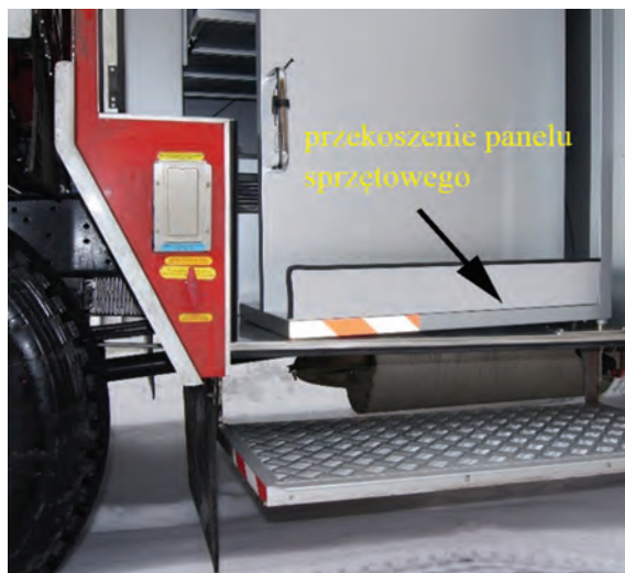
Ryc. 105. Przekoszenie panelu sprzętowego
