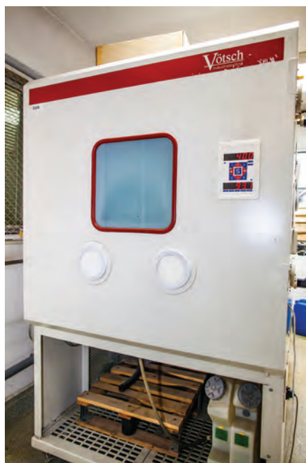
Ryc. 62. Stanowisko do badań odporności i wytrzymałości na działanie warunków atmosferycznych – komora klimatyczna
