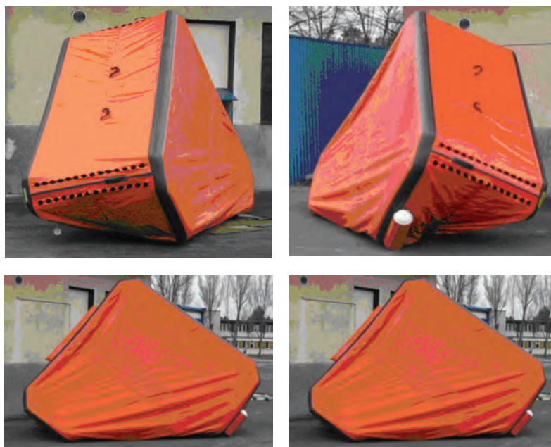
Ryc. 133. Przykłady braku stateczności skokochronu po upadku obciążenia testowego na jego powierzchnię
