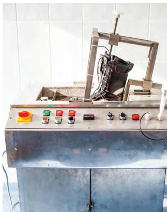
Ryc. 43. Widok ogólny stanowiska do badania butów strażackich na przemakanie
