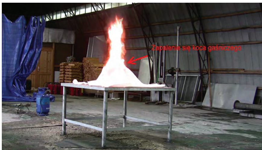
Ryc. 141. Brak wymaganej skuteczności gaśniczej koca gaśniczego: w warunkach rzeczywistego użytkowania ugaszenie pożaru takim kocem gaśniczym byłoby niemożliwe
