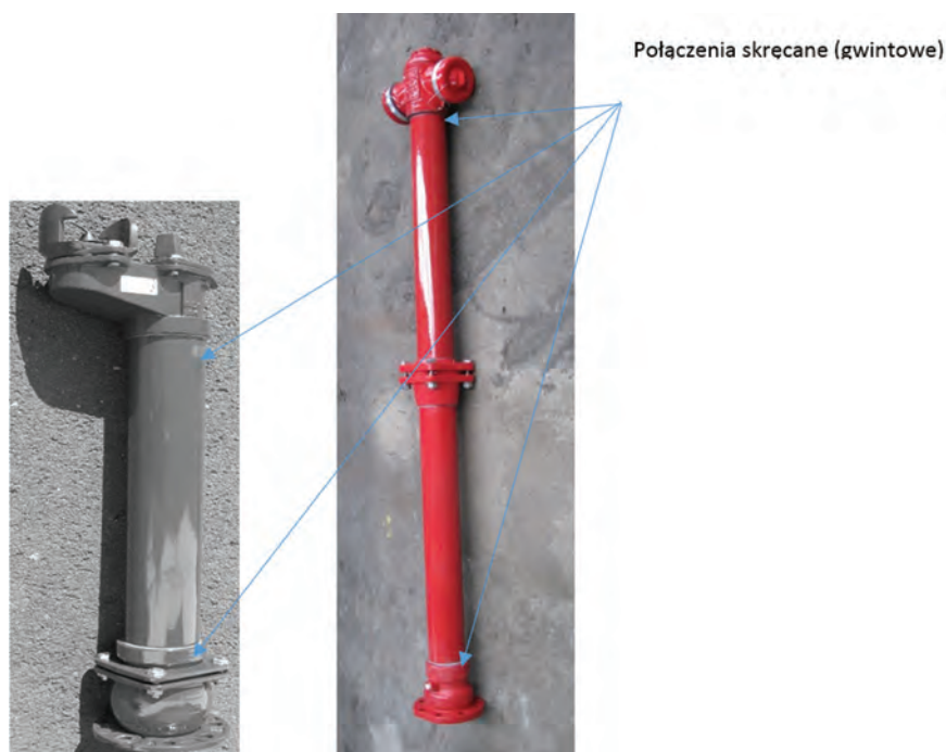
Ryc. 98. Niezgodność – miejsca pojawiania się nieszczelności
