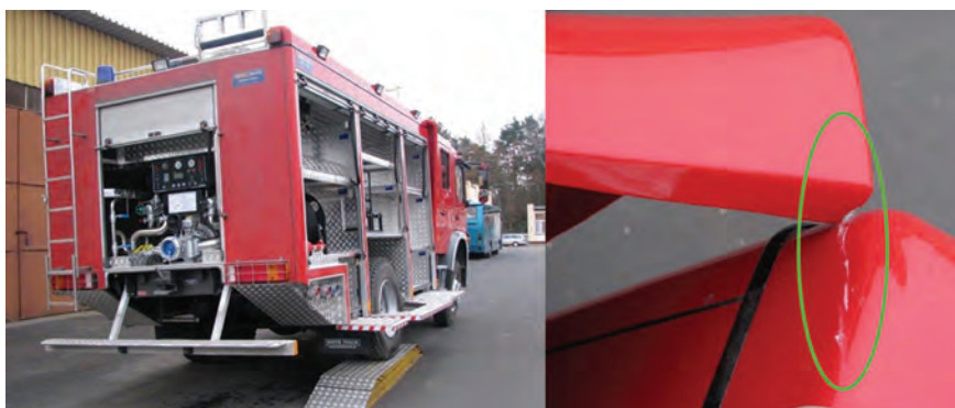
Ryc. 122. Kolizja zabudowy z kabiną pojazdu w trakcie próby krzyżowania osi – grozi uszkodzeniem konstrukcji zabudowy
