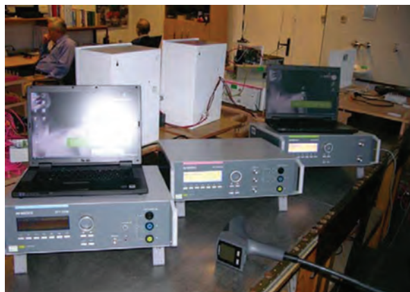
Ryc. 60. Widok generatorów do badań kompatybilności elektromagnetycznej (KEM) urządzeń
