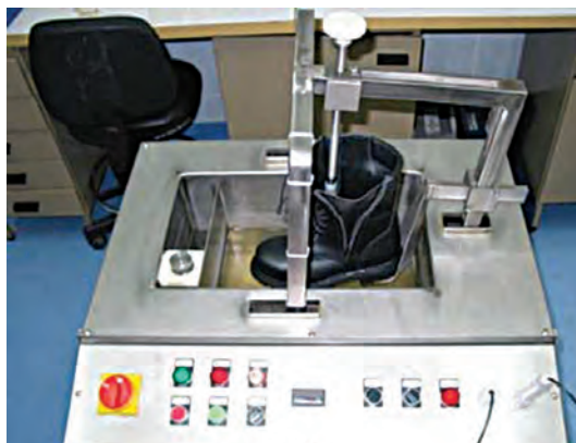
Ryc. 42. Stanowisko do badania butów strażackich na przemakanie (poziom zanurzenia obuwia w wodzie)
