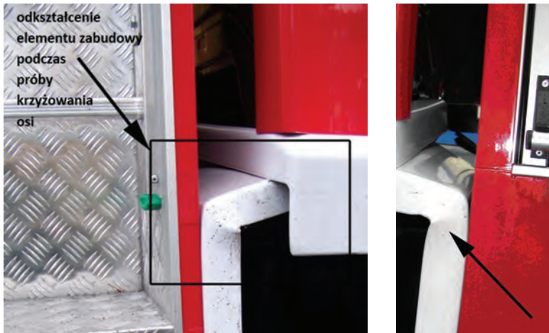
Ryc. 109. Odształcenie elementu zabudowy podczas próby krzyżowania osi – prowadzi do uszkodzenia elementów pojazdu pożarniczego
