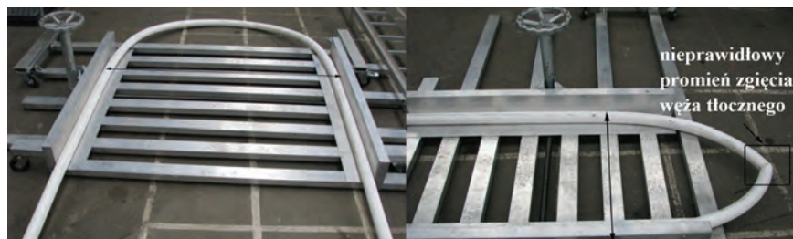
Ryc. 89. Nieprawidłowy promień zgięcia węża tłoczego – może spowodować niedostarczenie odpowiedniej ilości wody w czasie akcji gaśniczej
