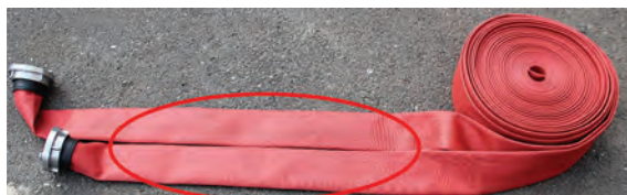
Ryc. 86. Pożarniczy wąż tłoczny do pomp pożarniczych z powłoką zewnętrzną – na obu końcach brak znakowania węża
