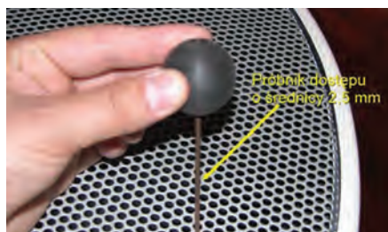
Ryc. 146. Obudowa głośnika do DSO niepełniająca stopnia ochrony obudowy IP3x, co powoduje możliwość wnikania do obudowy elementów o średnicy mniejszej niż 2,5 mm, a rezultacie – ryzyko uszkodzenia urządzenia i braku możliwości przekazania komunikatu ostrzegawczego
