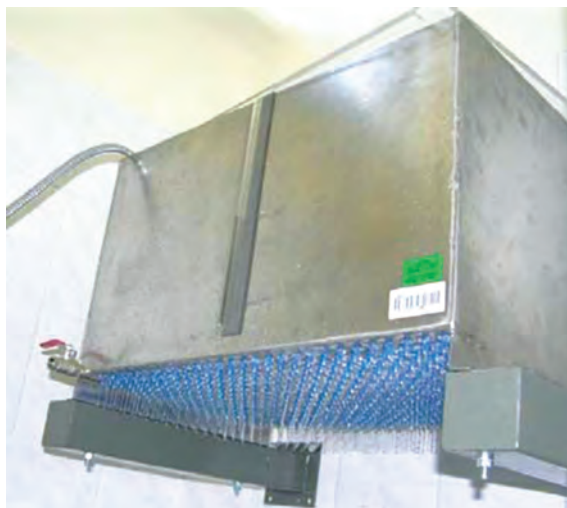
Ryc. 58. Skrzynia kroplowa – stanowisko do badania stopnia ochrony obudowy IP (badanie umożliwia sprawdzenie oddziaływania wody na urządzenie)
