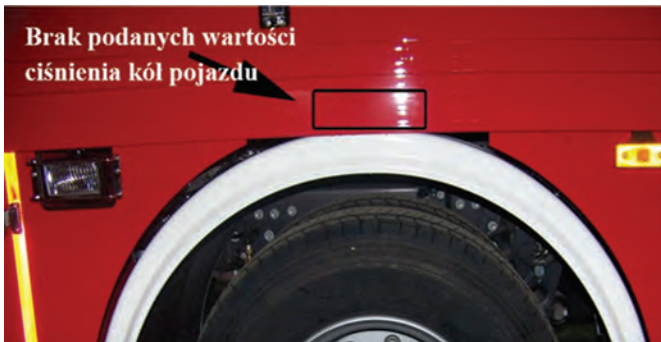
Ryc. 117. Niezgodność – brak informacji o ciśnieniu w kołach pojazdu pożarniczego może spowodować zniszczenie ogumienia i przewrócenie się pojazdu
