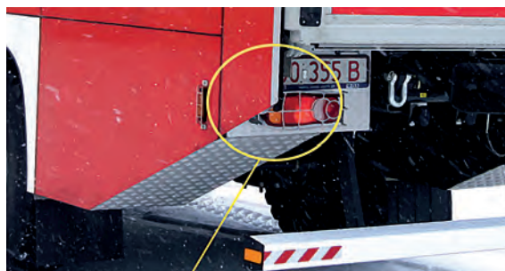
Ryc. 120. Tylne światła drogowe zasłonięte przez elementy zabudowy – zagrożenie w ruchu drogowym dla uczestników jadących za pojazdem
