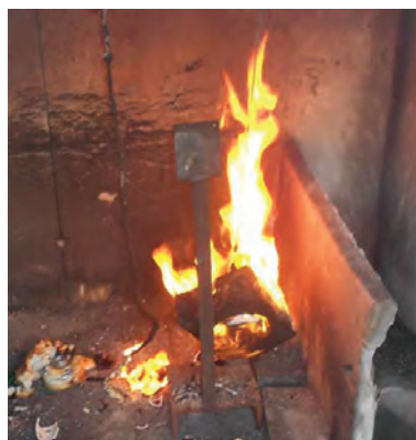
Ryc. 144. Palący się głośnik do DSO, który oderwał się od konstrukcji. Defekt uszkodził linię głośnikową, stwarzając zagrożenie dla użytkowników obiektu i/lub ratowników
