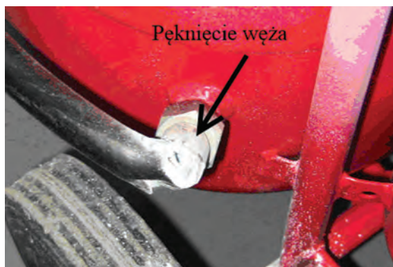
Ryc. 140. Nieodpowiednia odporność materiału, z którego wykonano wężyk, na temperaturę 60°C – uniemożliwia ugaszenie pożaru, m.in. dlatego, że środek gaśniczy nie wydostałby się poprzez prądownicę zamontowaną na końcu wężyka
