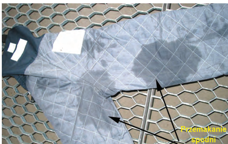
Ryc. 74. Brak spełnienia wymagania odporności na przemakanie spodni – zmniejszenie właściwości ochronnych na promieniowanie ciepłe, zmniejszenie komfortu pracy w ubraniu
