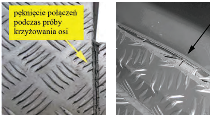
Ryc. 110. Pęknięcie (po lewej) lub odkształcenie się (po prawej) połączeń podczas próby krzyżowania osi prowadzi do uszkodzenia elementów pojazdu pożarniczego
