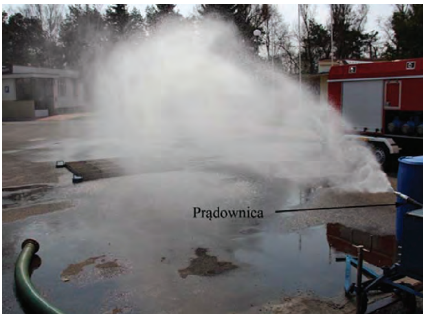
Ryc. 52. Stanowisko do badania maksymalnej długości rzutu strumienia rozproszonego prądownic
