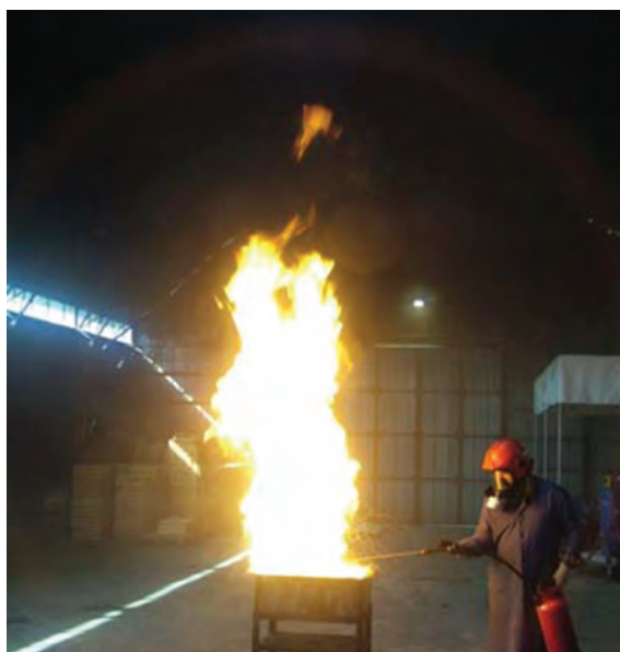
Ryc. 55. Badanie skuteczności gaśniczej w zakresie pożarów grupy F
