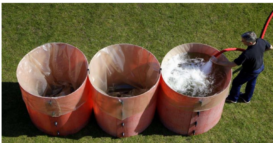
Rys. 7.12. napełnianie pionowych rękawów przeciwpowodziowych [159]
