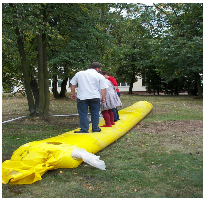
Rys. 7.23 Rękaw przeciwpowodziowy zastosowany jako kładka (wyk. Z. Ślosorz 7.09.2012r.)
