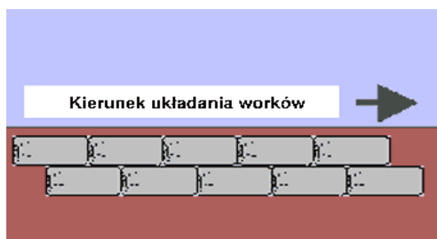
Rys. 7.3 Układanie worków na dwóch poziomach [144]
