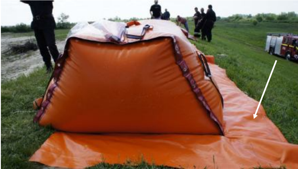
Rys. 7.14 Sprawiony rękaw przeciwpowodziowy o przekroju trapezowym [150]
