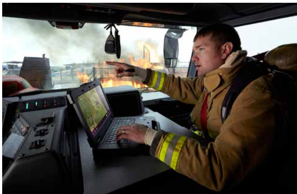
Ryc. 8. Komputer klasy laptop ze wzmocnioną obudową wykorzystywany do prezentacji danych w czasie akcji ratowniczej
