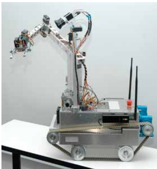
Ryc. 6. Mobilny robot inspekcyjno-interwencyjny Źródło: www.ciop.pl
