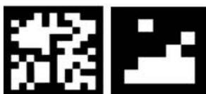
Ryc. 3. Przykładowe znaczniki stosowane w metodach rzeczywistości rozszerzonej.
