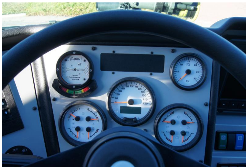
Fot. 3. Przykład umiejscowienia wyświetlacza urządzenia firmy Stability Dynamics na desce rozdzielczej pojazdu
