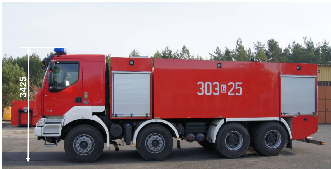
Fot. 4. Ciężki samochód ratowniczo-gaśniczy PN-EN 1846-1 S-2-3-8500-8/5000-1 (GCBA 8,5/50) na podwoziu RENAULT KERAX 8x4.
