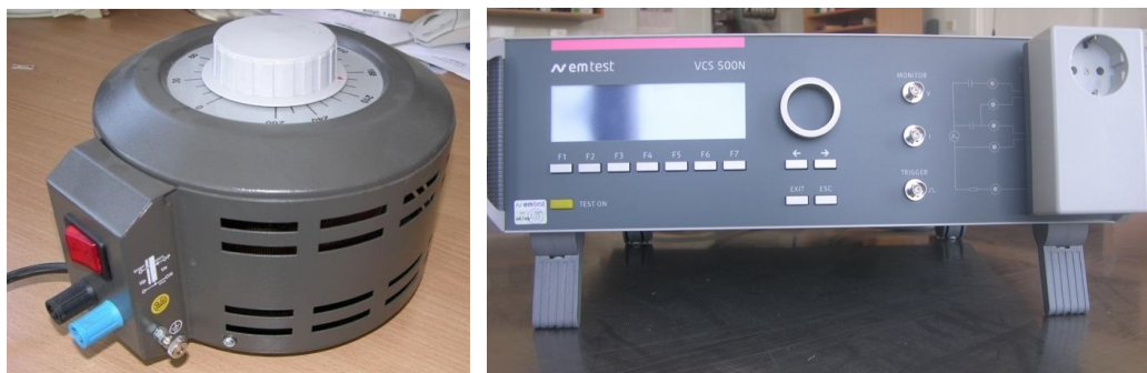
Ryc. 10. Wyposażenie do badania odporności na zapady i zaniki napięcia sieciowego
