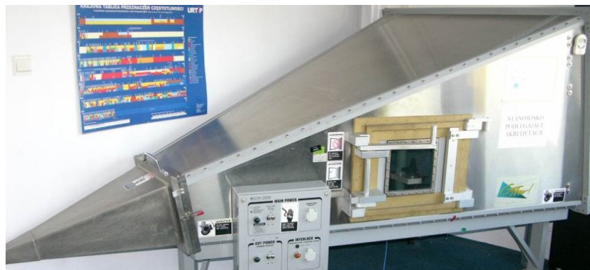
Ryc. 12. Wyposażenie do badania odporności na pola elektromagnetyczne
