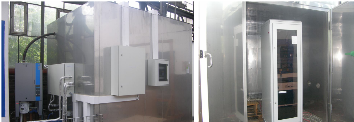
Ryc. 7. Widok komory do badań klimatycznych
