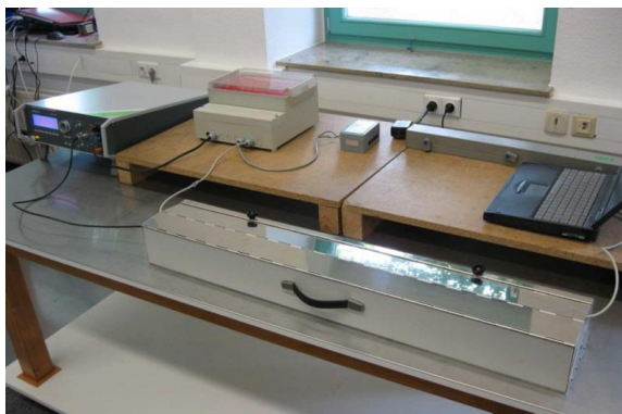
Ryc. 6. Wyposażenie do badania odporności na szybkie zakłócenia impulsowe Źródło: opracowanie własne
